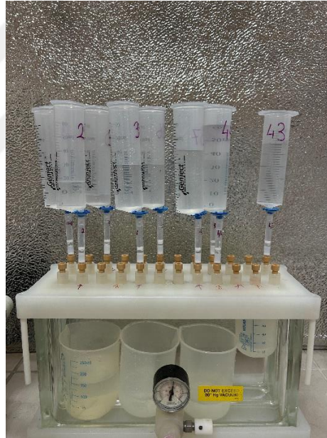
Şekil 3.6. Aflatoksin B1'e özgü immünoafinite kolon kullanarak vakum manifoldunda AFB1'in ekstraksiyonu.
