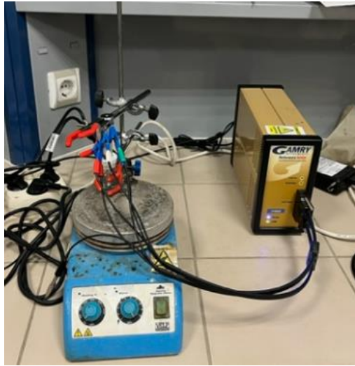
Şekil 2.12 Gamry Instruments Reference 600+ potentiostat/galvanostat cihazı
