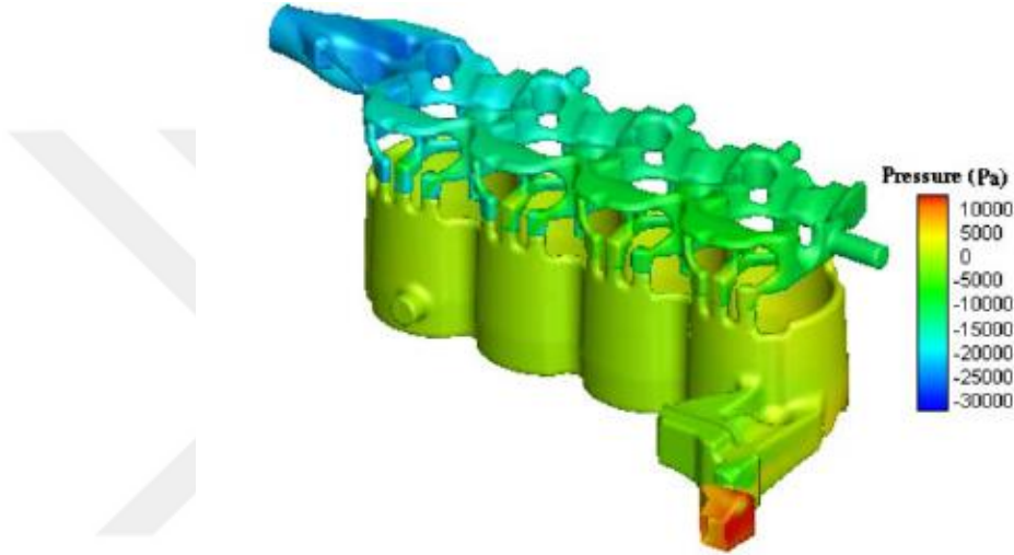
Şekil 2.7. Motor su ceketi basınç görseli (Fathallah ve ark. 2007)
