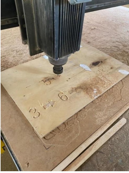
Şekil 24. Materyal 1, cnc ahşap kesme makinesi ile ahşabın hazırlanması
