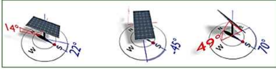
ekil 3.6.. Çift eksenli güne takip sistemi
