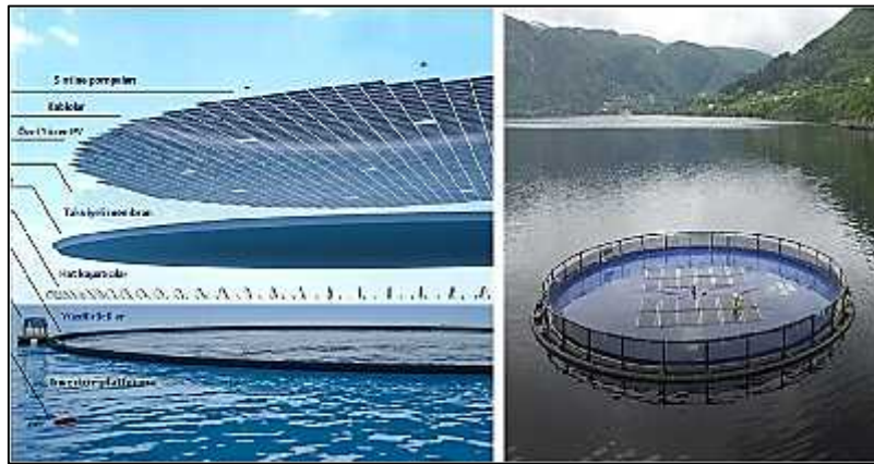
ekil 4.9. Modüller yapının ve PV modüllerinin dalgalarla sorunsuz hareket etmesini sa layan ince ve esnek takviyeli membran üzerine kaynaklanmı çift profil üzerine kurulu FPV [78].
