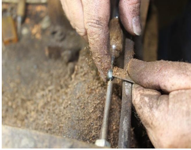
Şekil 4.1.5 6. Arda ile şekillendirme (Kocaman, 2023).
