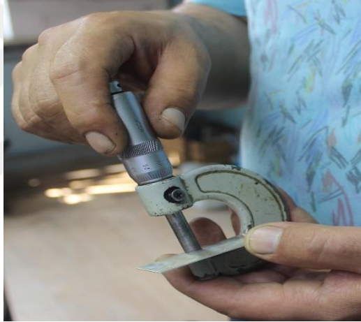
Şekil 4.1.4.2 2. Mikrometre ile gümüş levha kalınlık ayarı (Kocaman, 2023).
