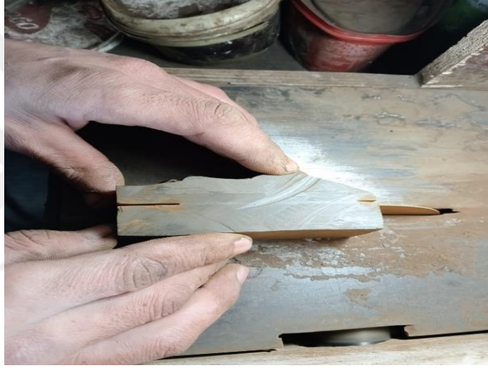
Şekil 4.1.2. 4. Elmas uçlu kesme makinası ile kesim yapılması (Kocaman, 2023).
