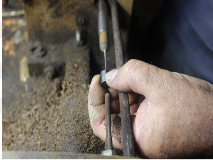
Şekil 4.1.5 4. Oltu taşının delici uç ile tornada delinmesi (Kocaman, 2023).
