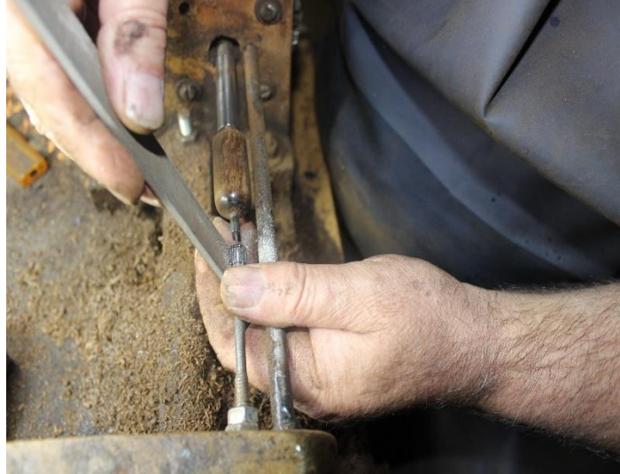
Şekil 4.1.5 8. Torna makinasında eğeleme işlemi
