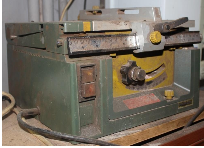
Şekil 4.1.2. 3. Elmas uçlu kesme makinası (Kocaman, 2023).
