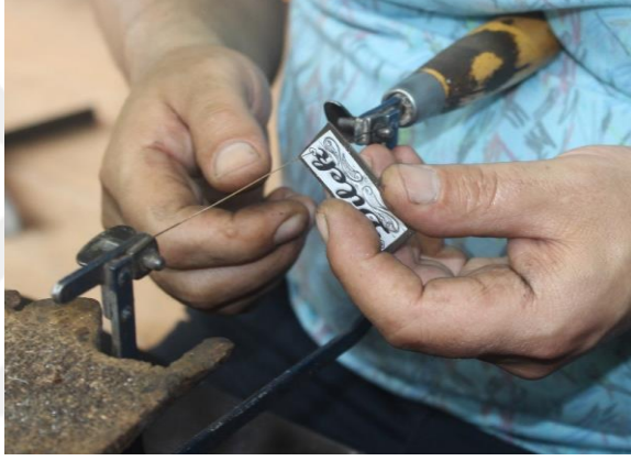
Şekil 4.1.4.2 5. Kıl testerenin geçirilmesi (Kocaman, 2023).
