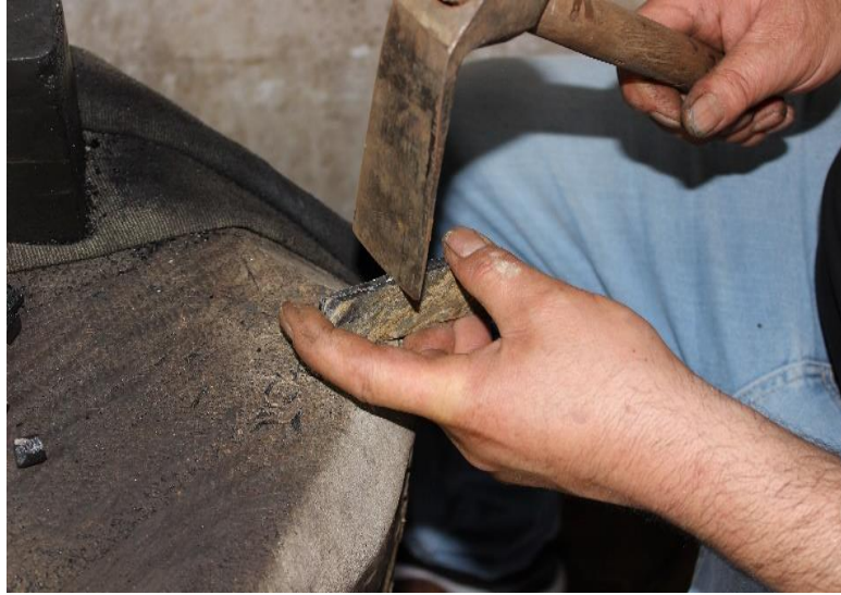
Şekil 4.1.5 2. Keser yardımı ile kırma (Kocaman, 2023).
