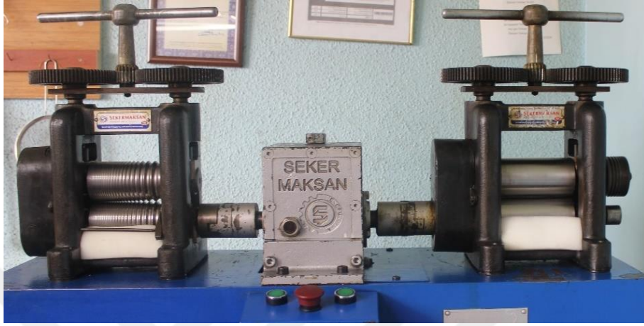
Şekil 4.1.2. 6. Elektrikli tel, astar çekme silindiri (Kocaman, 2023).
