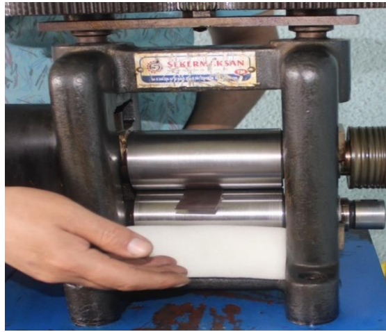
Şekil 4.1.4.2 3. Silindirden geçirme işlemi (Kocaman, 2023).
