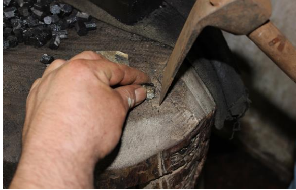
Şekil 4.1.3.1.2. Keserle kırma işlemi (Kocaman, 2023).
