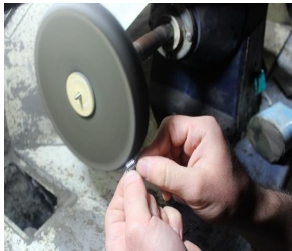
Şekil 4.1.2. 10. Ponza ile pürüzlerin giderilmesi (Kocaman, 2023).
