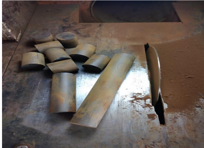
Şekil 4.1.2. 5. Elmas uçlu kesme makinası ile kesilmiş maden (Kocaman, 2023).
