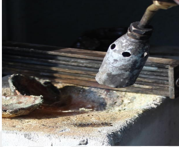
Şekil 4.1.4.2 8. Pürümüz ile tavlama (Kocaman, 2023).
