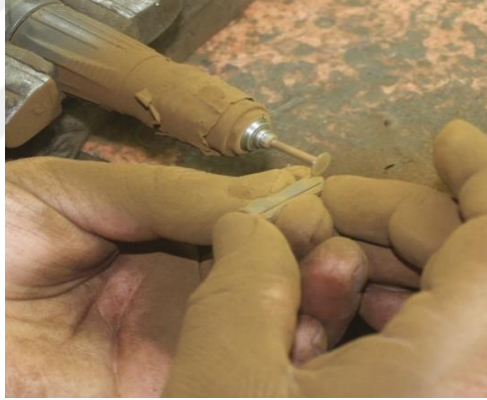
Şekil 4.1.3.3 2. Freze ile yarma işlemi (Kocaman, 2023).
