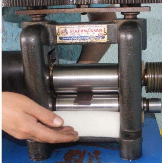
Şekil 4.1.2. 7. Gümüşün levha haline getirilmesi (Kocaman, 2023).
