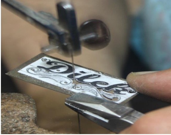
Şekil 4.1.4.2 6. Kıl testere ile kesme işlemi (Kocaman, 2023).
