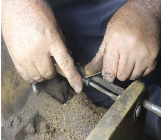
Şekil 4.1.5 5. Keski ile düzeltme (Kocaman, 2023).
