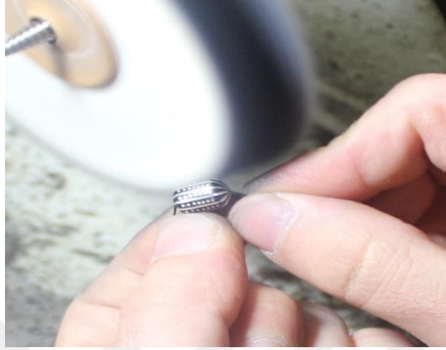
Şekil 4.1.5 9. Ponza makinasında parlatma ve cila işlemi (Kocaman, 2023).
