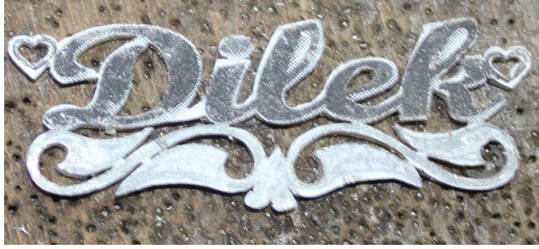
Şekil 4.1.4.2 7. Kesme (Ajur) işlemi tamamlanmış şablon (Kocaman, 2023).
