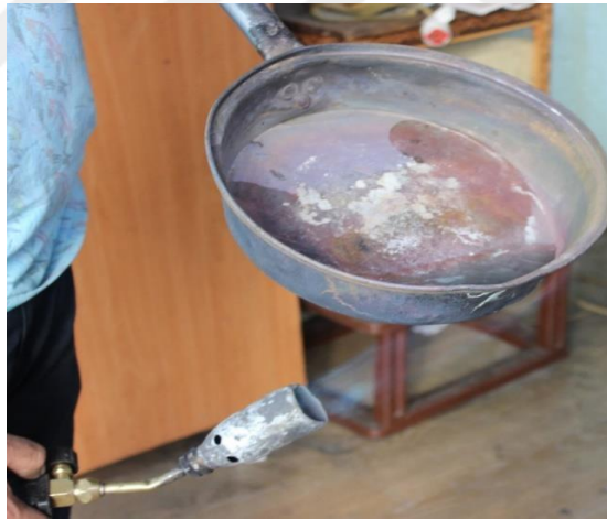
Şekil 4.1.4.2 9. Asitte ağartma işlemi (Kocaman, 2023).
