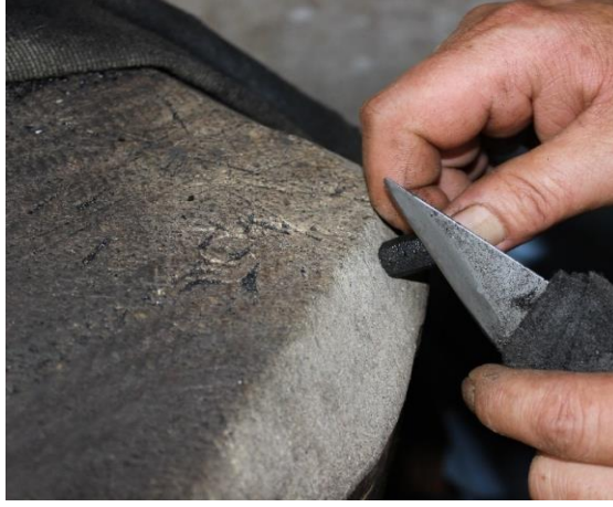
Şekil 4.1.3.1 4. Yontma – elde şekillendirme tekniği (Kocaman, 2023).
