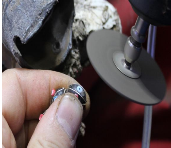
Şekil 4.1.4.3 6. Sipiral ile törpüleme (Kocaman, 2023).
