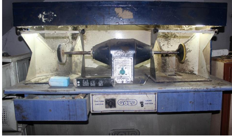
Şekil 4.1.2. 8. Vakumlu ponza-cila motoru (Kocaman, 2023).
