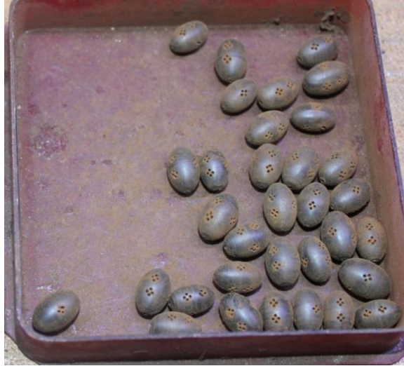
Şekil 4.1.4.3 3. Delme İşlemi tamamlanmış tespih taneleri (Kocaman, 2023).
