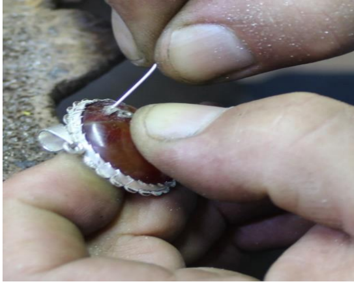
Şekil 4.1.4.7 2. Gümüş telin geçirilmesi (Kocaman, 2023).
