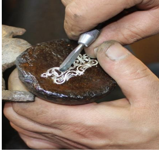
Şekil 4.1.4.1 10. Kalem atma işlemi (Kocaman, 2023).
