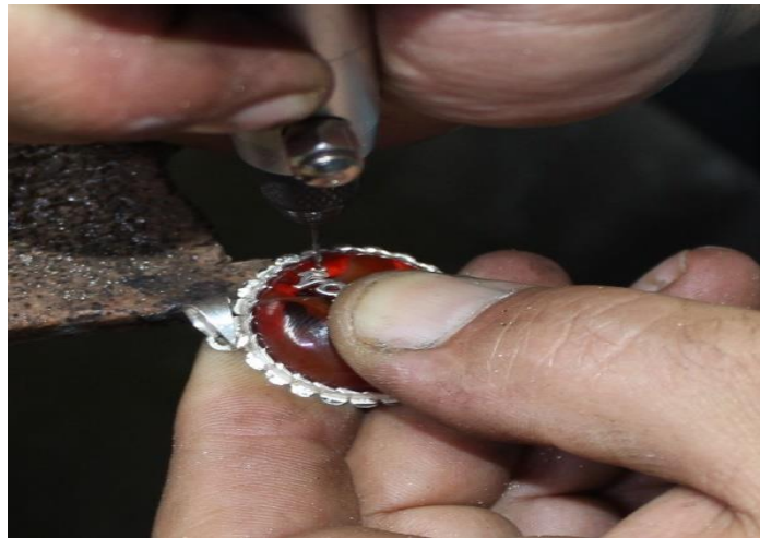
Şekil 4.1.4.7 1. Freze matkapla delme işlemi (Kocaman, 2023).
