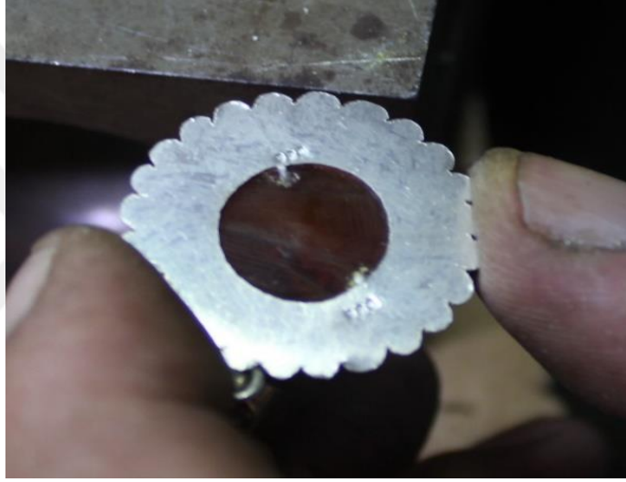
Şekil 4.1.4.7 3. Perçin çekici ile dövülmüş uçlar (arka yüz) (Kocaman, 2023).
