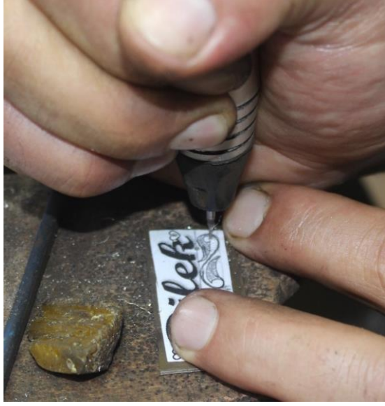
Şekil 4.1.4.2 4. Freze matkap ile delme işlemi (Kocaman, 2023).
