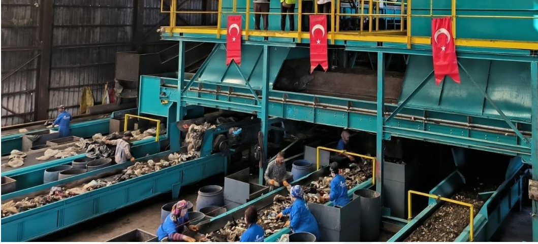
Şekil 7. Samsun Avdan Enerji Mekanik Ayırma Tesisi
