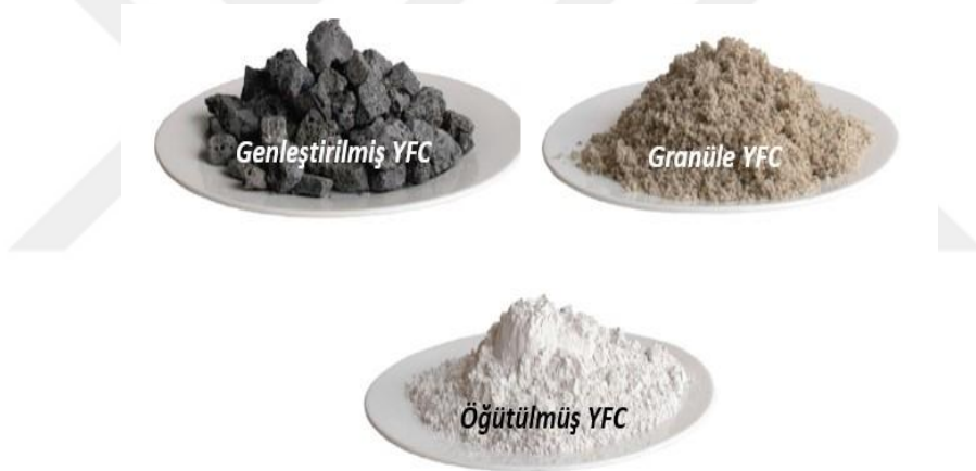
Şekil 4. Soğutma tipine göre yüksek fırın cürufları (Anonim a 2024)
