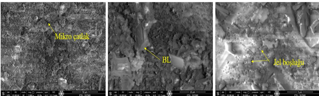
Şekil 52. 600 °C'ye maruz bırakılmış GP_2.5_2 (su ile kürlenmiş) numunesinin mikroyapısı
