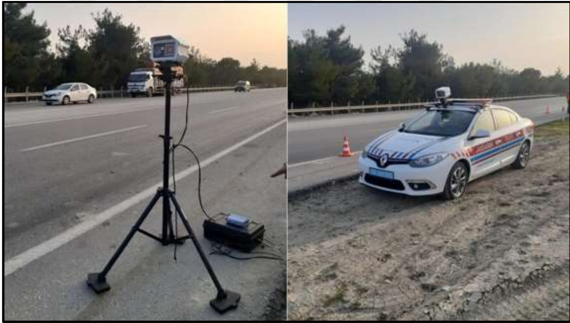
Resim 2.1. Radar cihazları ile hız denetimi uygulaması
