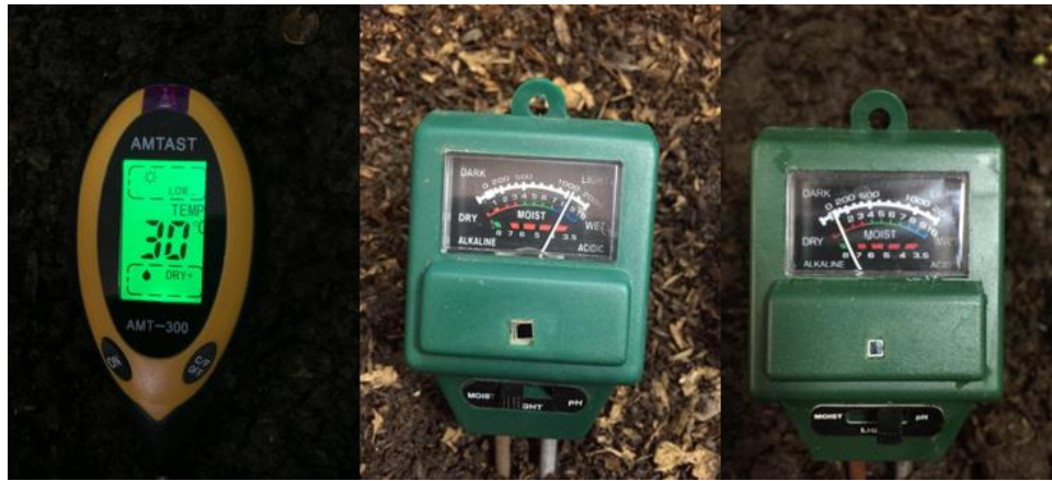
Şekil 3.17 : Reaktördeki sıcaklık, nem ve pH değerlerinin takibi.
