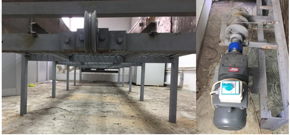
Şekil 3.9 : Bıçağın hareketini sağlayan makara sistemi ve motor.
