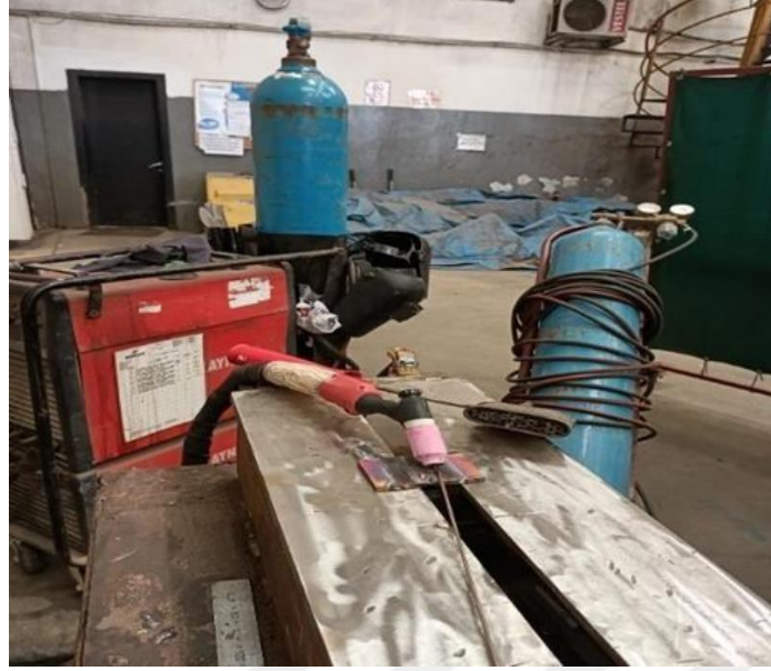
Şekil 3.10. Kaynağı Yapılmakta Olan Test Parçası
