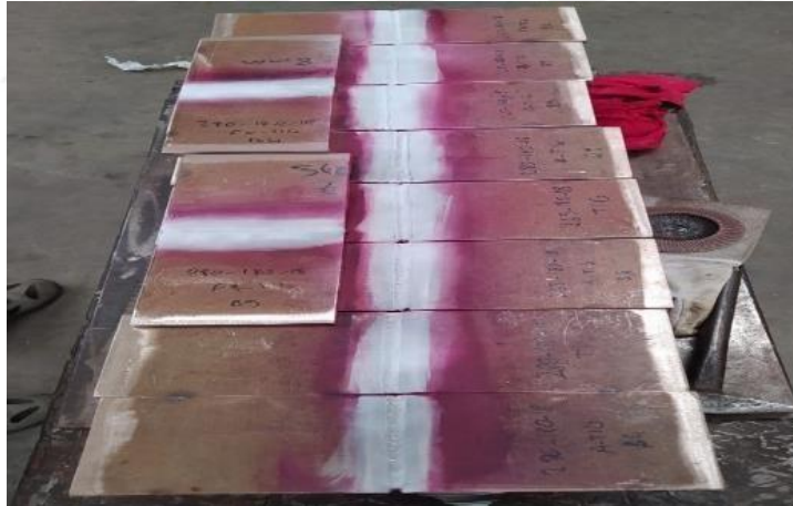
Şekil 4.50. Boya-penetrasyon Uygulanan Kaynak Dikişi Görseli
