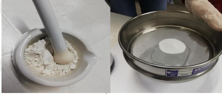
Şekil 3.5. Bileşiklerin (a) Havanla İnceltilmesi ve (b) Elekle Boyutlanması
