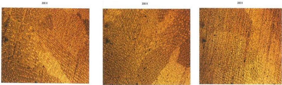
Şekil 4.42. BOM4 Aktif Örtü ve 280 A Akım Şiddetinde Gerçekleştirilmiş Kaynak Dikişlerinin Mikroyapıları x 200: (a) A-TIG, (b) FB-TIG ve (c) TIG
