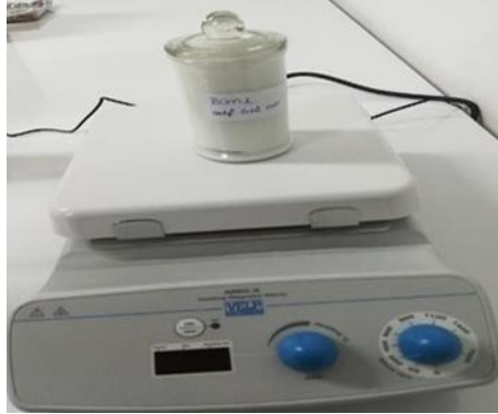
Şekil 3.8. Süspansiyon Homojenizasyonu için Kullanılan Manyetik Karıştırıcı Hazırlanan aktif örtü süspansiyonu, Şekil 3.9'da gösterildiği üzere kaynak bölgesine uygulanmıştır.
