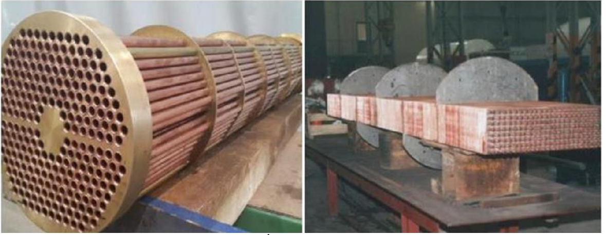
Şekil 1.1. 90/10 CuNi Alaşımı Kullanılarak İmal Edilmiş Isı Değiştiriciler (BOMAK Ltd.Şti.) 90/10
