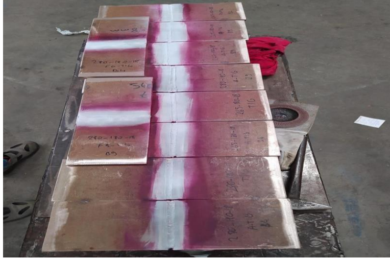
Şekil 3.13. Dye-penetration Uygulanmış Kaynak Bölgesinin Görseli
