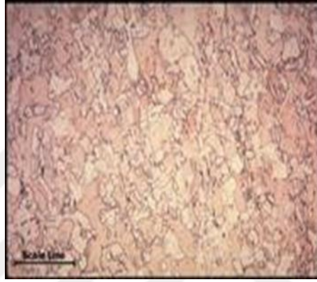
Şekil 4.40. 90/10 CuNi Haddelenmiş Sac Plakanın Orijinal Mikroyapısı ( Copper- Nickel Welding and Fabrication)(2013)
