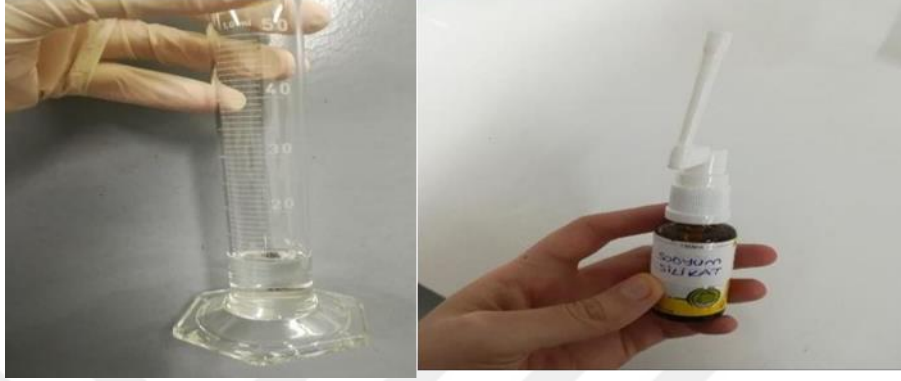
Şekil 3.7. Süspansiyonun (a) elle karıştırılması ve (b) Sodyum Silikat İlavesi
