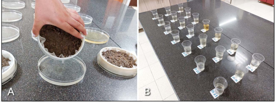
Fotoğraf 3.5. A: bekleme süresi biten örnek çamurlarının alınması, B: Petri tabanındaki nematodlu suyun bardaklara alınması
