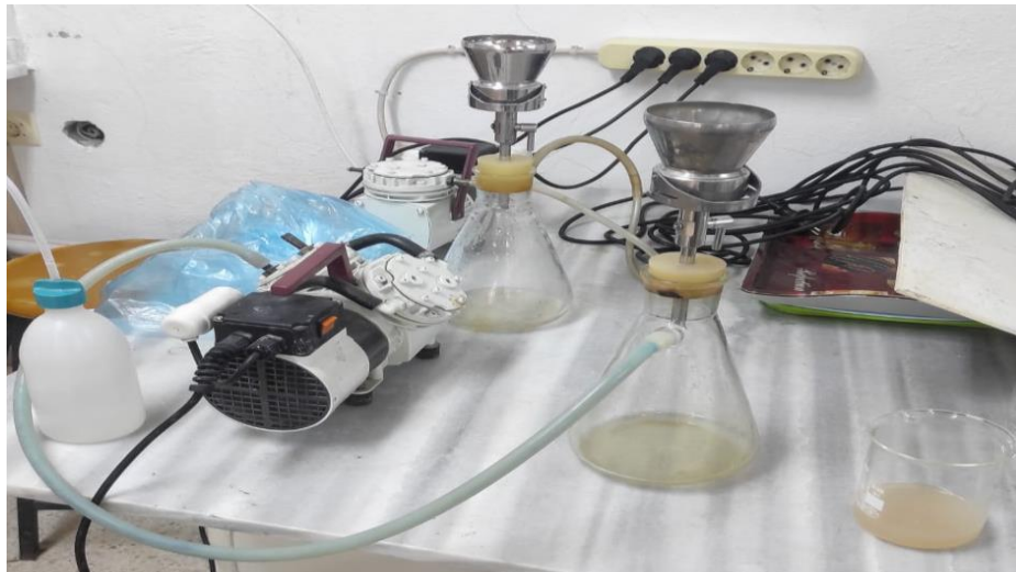
Şekil 3.1. Ham atıksuyun süzme düzeneği
