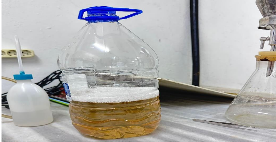
Şekil 3.2. 0.2 µ'luk mikrofiltreden geçirilen atıksu
