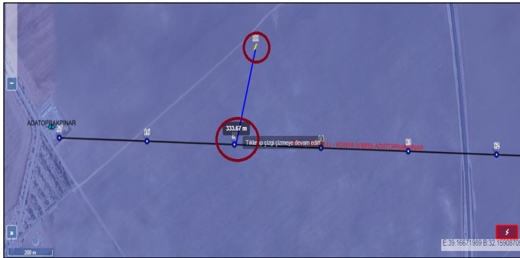
Şekil 4.16. 154 kV Adatoprakpınar-Konya hattına 333.67 m uzaklıkta boş arsaya düşen YEMD’in kublaj etkisi
