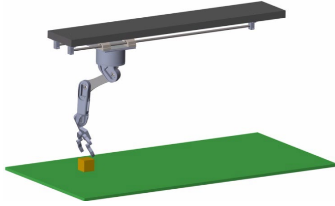
Şekil 6.7. Ters Robot Kol Mekanizmasının Hedef Parçayı Belirlenen Konuma Bırakması
