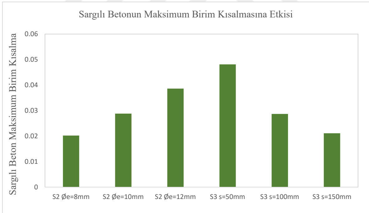
Şekil 61. Etriye oranının sargılı beton maksimum birim kısılmasına etkisi
