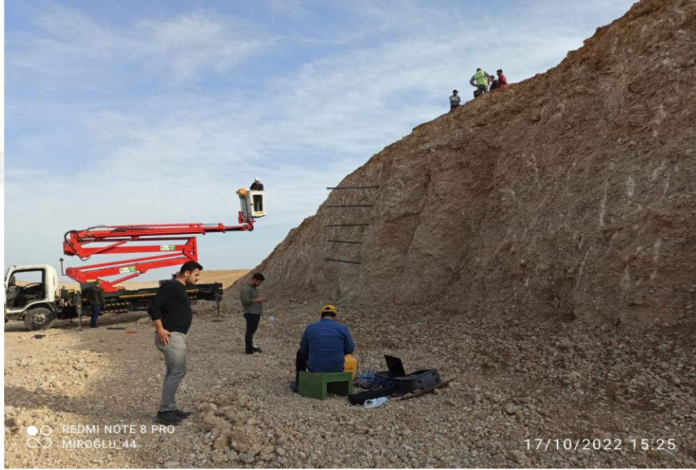
Şekil 3.16. Palyeye ivme ölçerlerin yerleştirilmesi
