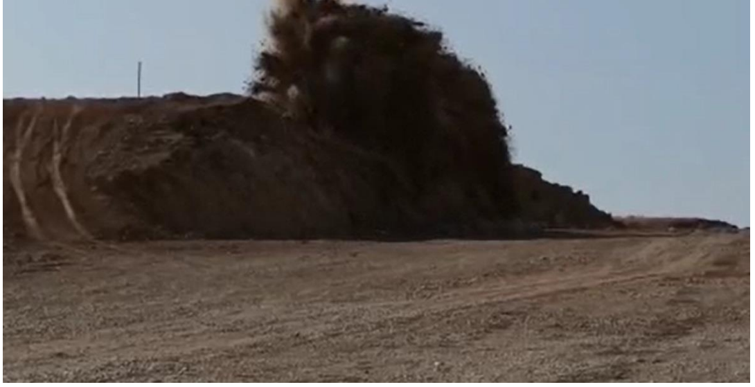
Şekil 3.18. Şev patlatmasına ait görüntü
