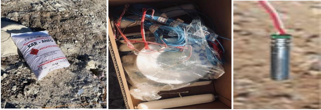
Şekil 3.5. Anadolu patlayıcıdan temin edilen Anfo, jelatin dinamit ve elektrikli fûnye görünümü
