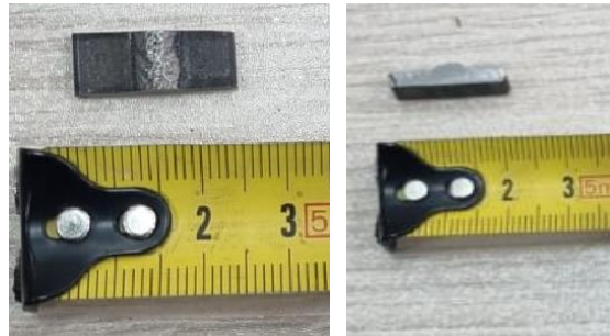
Şekil 4. 15. Sertlik ölçümleri ve mikroyapı karakterizasyonu amaçlı hazırlanan numune görselleri
