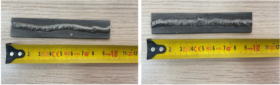
Şekil 4. 16. Çekme testlerinde kullanılan test numunelerin tipik bazı görselleri
