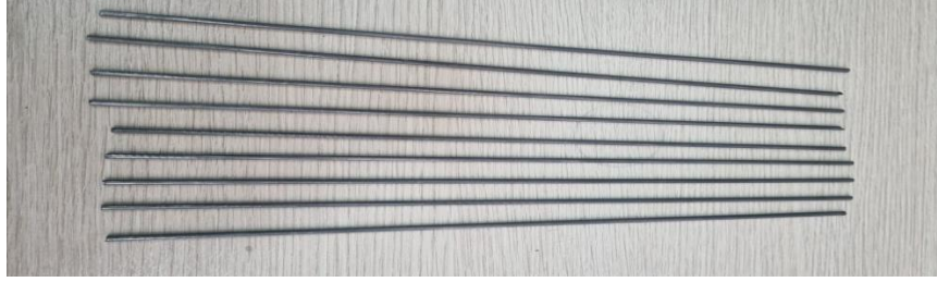
Şekil 4. 1. Örtülü elektrot üretiminde kullanılan filmaşın teller
