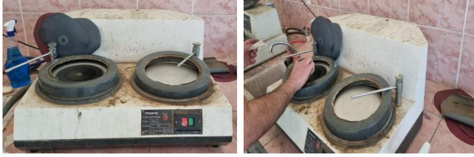
Şekil 4. 14. Zımparalama ve parlatma amaçlı kullanılan diskler
