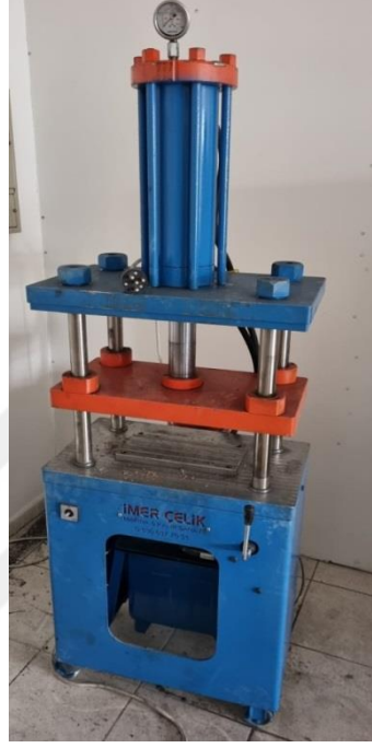
Şekil 4. 4. Örtülü elektrot üretiminde kullanılan presleme makinesi
