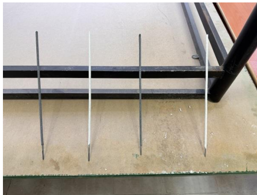
Şekil 4. 7. Kalıpta presleme yöntemi ile üretilen örtülü elektrotların tipik görselleri
