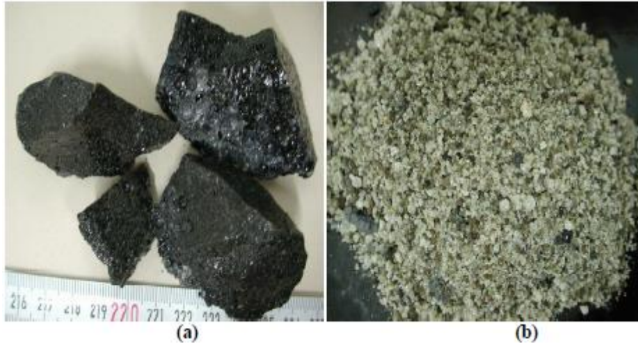
Şekil 2. 12. Yüksek fırın cüruf tipik görüntüleri (a) havada atmosfere açık ortamda soğutulan (b) hızlı soğutma şartlarında soğutulan
