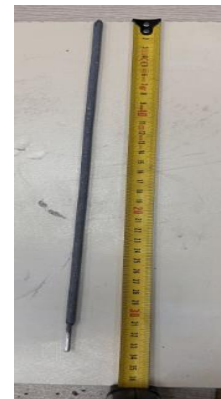
Şekil 4. 7. Kalıpta presleme yöntemi ile üretilen örtülü elektrotların tipik görselleri
