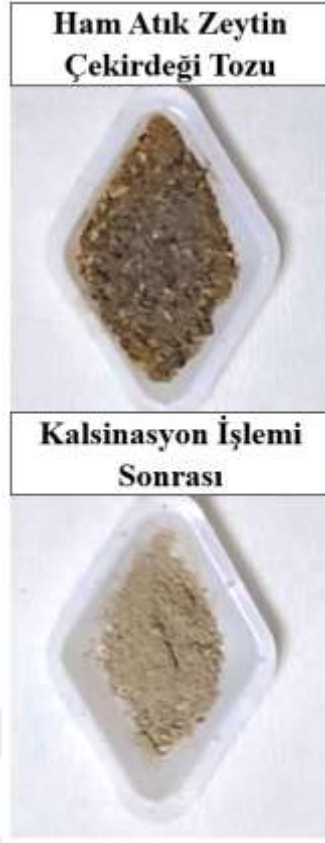
Şekil 3.2. Zeytin çekirdeğinin 900 °C'de 2 saat kalsinasyon işlemi öncesi ve sonrasına ait görüntüler
