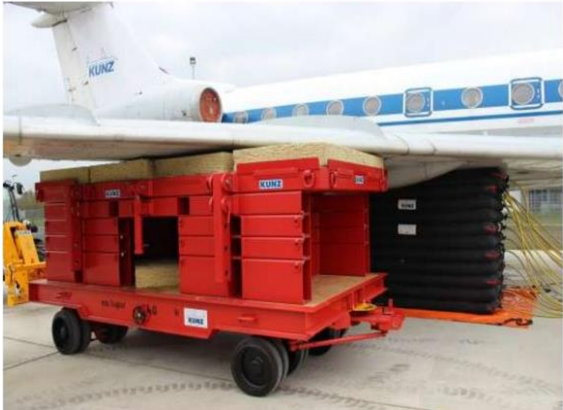
Resim 2.3. Uçak kurtarma teçhizatı yerleşimi 3. ve 4. Adım [7]
