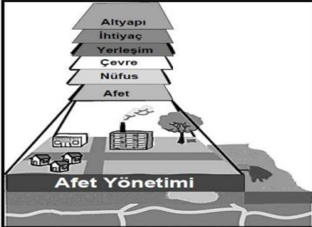
Şekil 2.16. Afet yönetim sistemi için CBS veri tabanında olabilecek katmanlardan bazıları [31]
