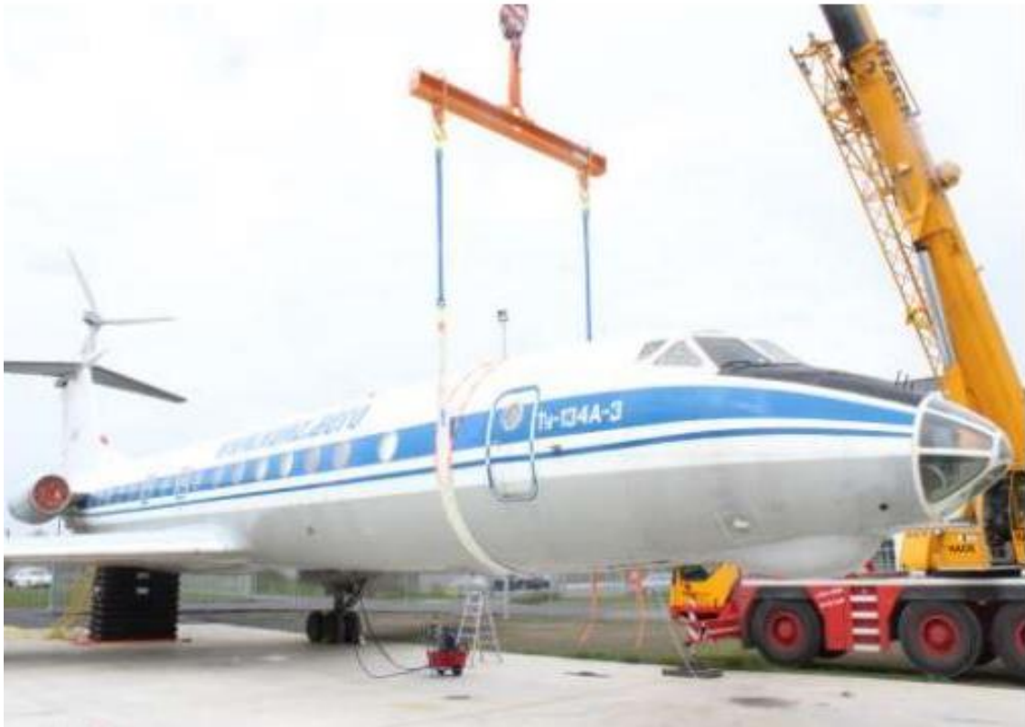
Resim 2.2. Uçak kurtarma teçhizatı yerleşimi 1. ve 2. Adım [7]
