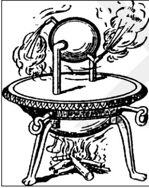
Şekil 2.1. İskenderiyeli Heron tarafından geliştirilen Aeolipile (Hero motoru) [2]
