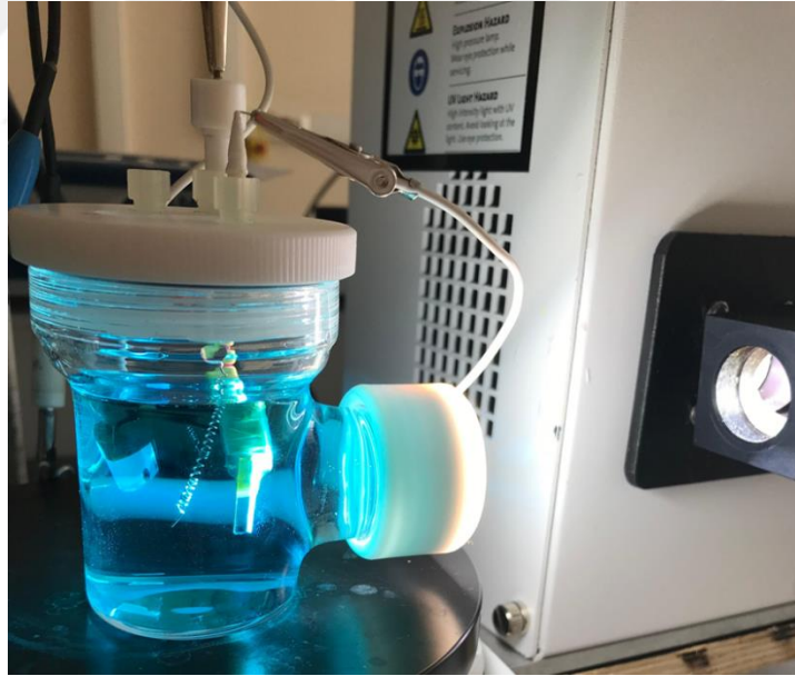
Şekil 4.34: Fotoelektrokimyasal gideriminde kullanılan iki elektrotlu hücre sistemi.
