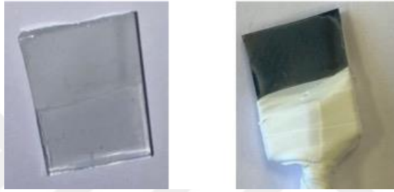
Şekil 4.10: TiO 2 /ERGO ve Mg-TiO 2 /ERGO elektrotlarının görüntüleri.
