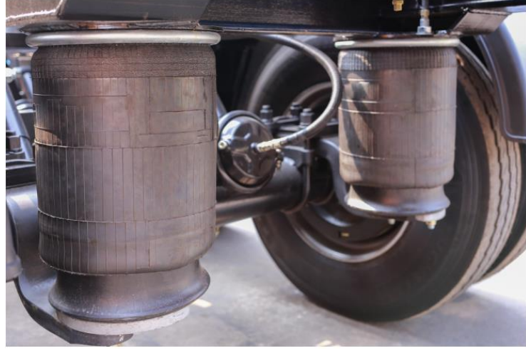
Şekil 2.2. Süspansiyon sistemlerinde kullanılan hava körükleri (Anonim, 2023)
