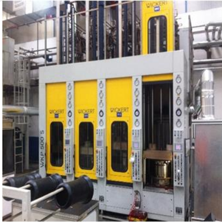
Şekil 2.12. Vulkanizasyon presleri (Sampa Otomotiv, tarihsiz)
