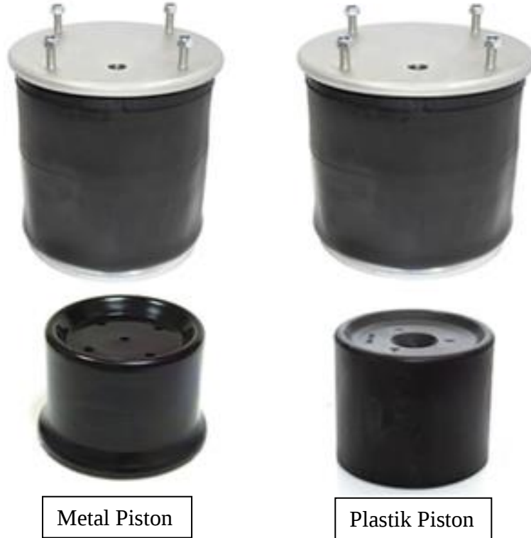
Şekil 2.15. Hava körüklerinde kullanılan metal (sol) ve plastik (sağ) pistonlar (Sampa Otomotiv, tarihsiz)
