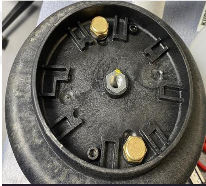
Şekil 4.10. Sinterlenmiş filtrelerin piston üzerindeki konumu
