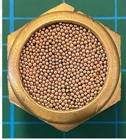
Şekil 4.6. Bakır partiküllerinden sinterlenmiş gözenekli akış sınırlayıcı eleman (Carbos, tarihsiz)
