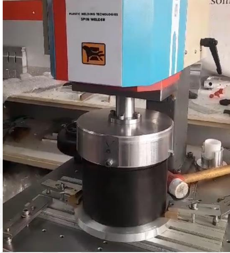
Şekil 4.3. Döndürme kaynağı makinesi ve aparatları
