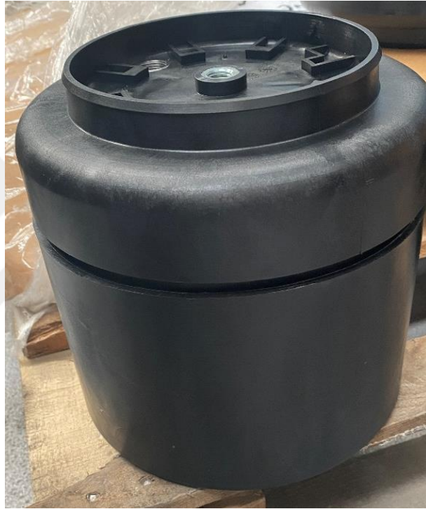
Şekil 4.2. Kaynak işlemine hazır üst ve alt piston
