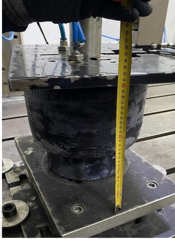
Şekil 4.11. Hava körüğünün test düzeneğine bağlanması
