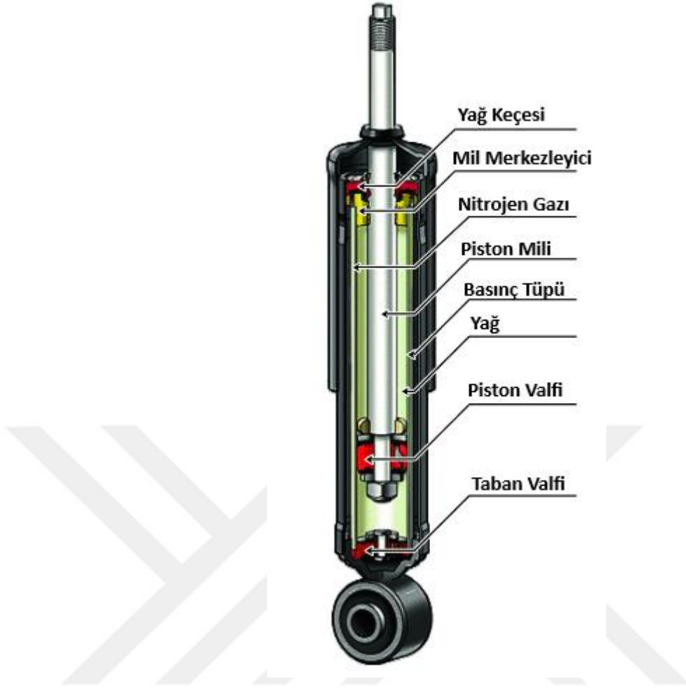
Şekil 1.4. Çift tüplü bir amortisörün iç yapısı (Anonim, 2015)
