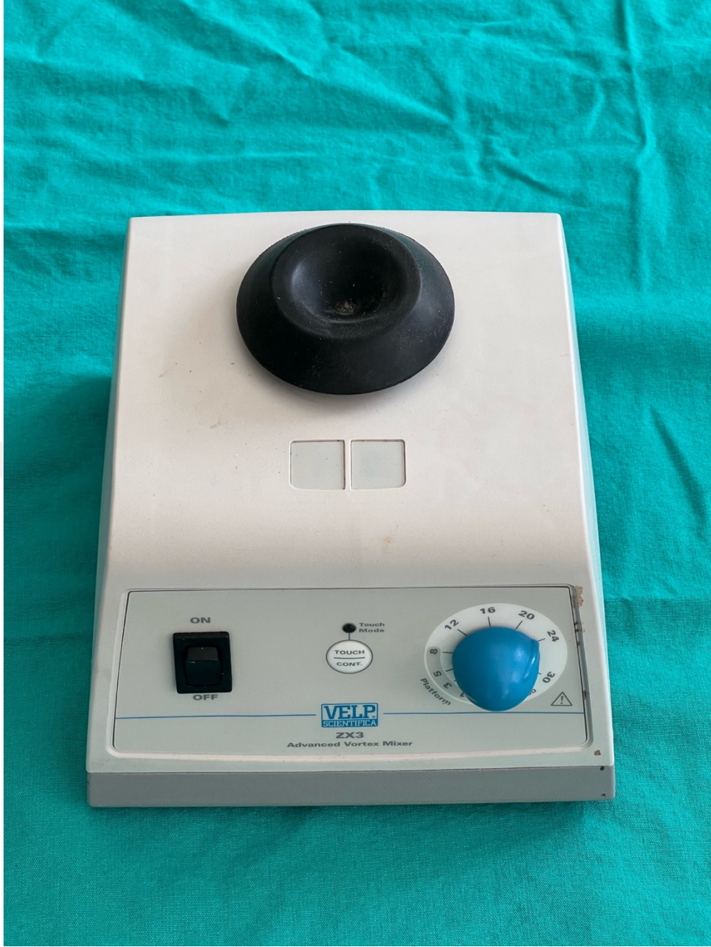
Şekil 22. Vibratör mikser (Vortex mixer, VELP Scientifica, İtalya)
