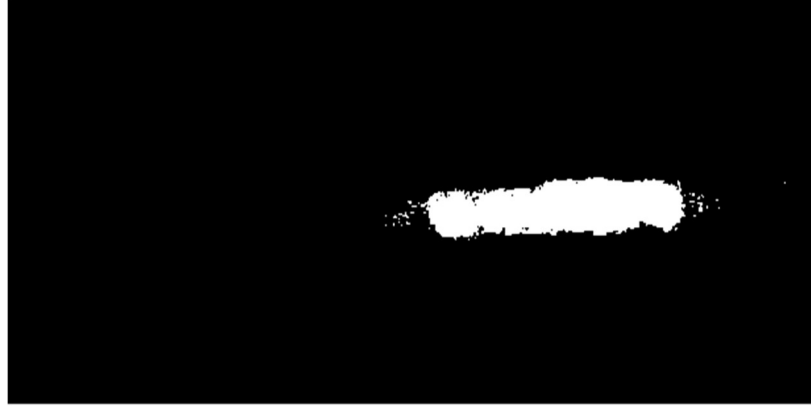
Şekil 26. Kaynak taşmasına ait eşiklenmiş görüntü
