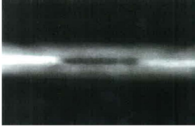
Şekil 10. Dahili iç büyüklük hatasının NDT filminde görünümü (Fujifilm radiographic reference chart)
