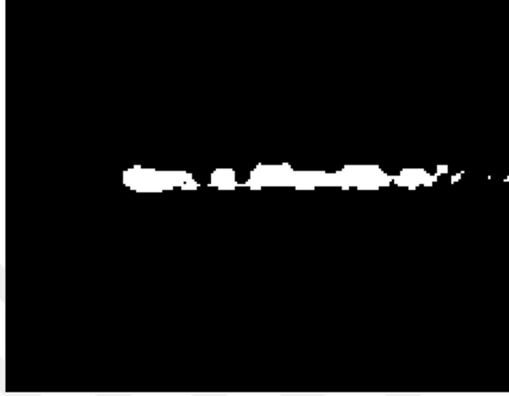
Şekil 36. Füzyon hatası eşiklenmiş görüntü
