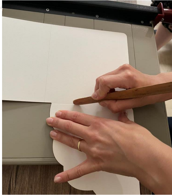
Şekil 53. Resimli hareketli kitap üretiminde, lazer kesim sonrası katlanacak alanlarda ‘kıрма’ işlemi görseli.
