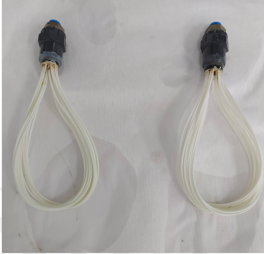
Şekil 4.20: Faz III, kimyasal yıkama sonrası Kontrol-MBR ve QQ-MBR membran modülleri.
