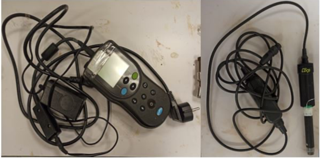
Şekil 3.5: Multiparametre ölçüm cihazı ve çözünmüş oksijen probu.
