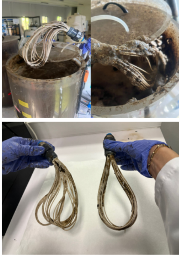
Şekil 4.5: Faz I, kimyasal yıkama öncesi QQ-MBR (sol) ve Kontrol-MBR (sağ) membran modülleri.
