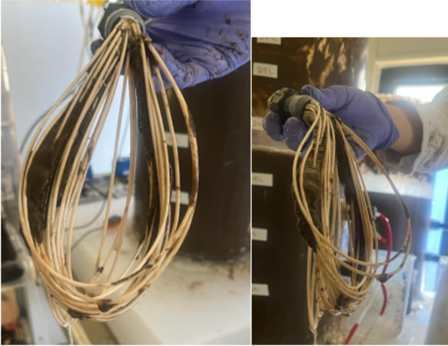
Şekil 4.13: Faz II, işletme sonrasında Kontrol-MBR membran modülü.
