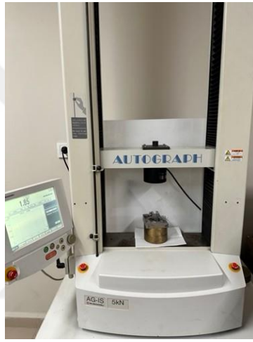
Şekil 3-10: Makaslama bağlanma dayanımı testinde kullanılan Instron Universal test cihazı.
