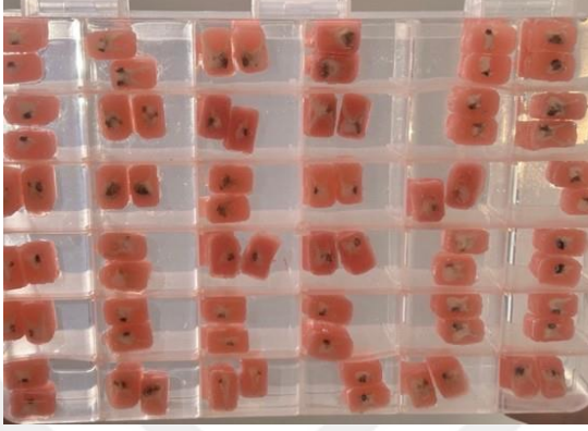
Şekil 3-16: Yapay tükürük içerisinde saklama kutusuna yerleştirilen örnekler.
