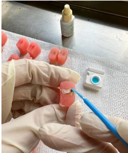
Şekil 3-13: Mikrofırça ile örneklerle kavite hazırlayıcı uygulaması.
