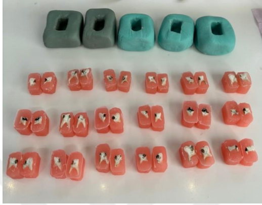
Şekil 3-12: Dişlerin gömülmesi için hazırlanan silikon kalıplar ve bölünen ara yüzey dışarıda kalacak şekilde akriliğe gömülmüş örnekler.
