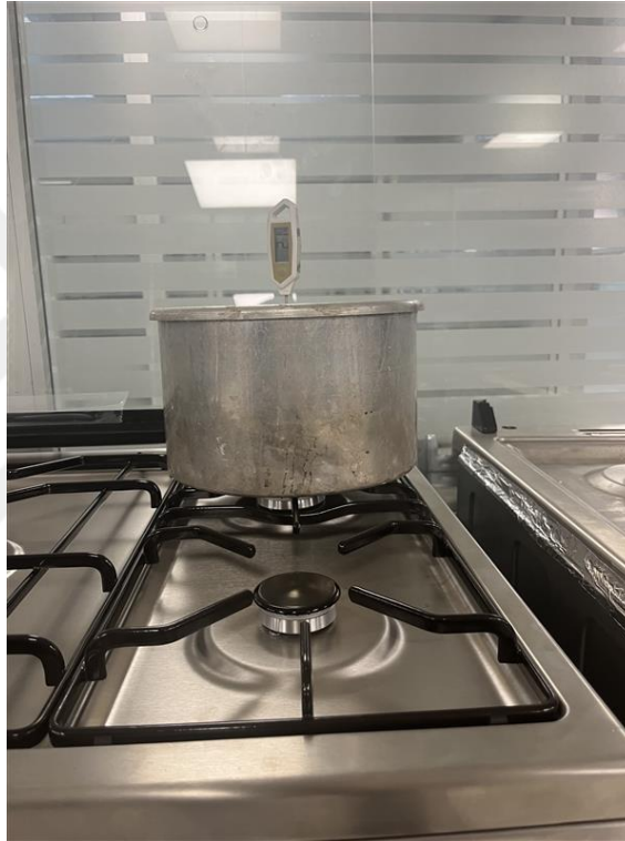
Şekil 3.6 Yanma Verimi Ölçümü Tenceresi ve Manometre Yerleşimi Görseli
