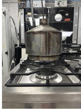
Şekil 2.7. Emisyon Ölçüm Tenceresi ve Kapak Yerleşim Görşeli
