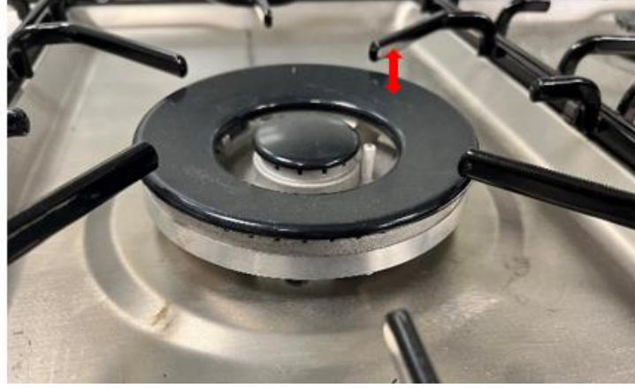
Şekil 3.10. Lama Izgara Üst Noktası/Alev Portları Mesafesi Görseli
