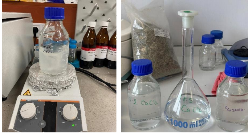
Şekil 3.5: Kalsiyum klorür çözeltisinin hazırlanışı.
