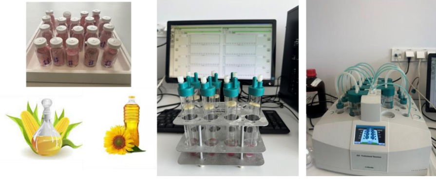
Şekil 3.12: Mikrokapsüllerle zenginleştirilmiş yağların oksidatif stabilite ölçüm süreci.
