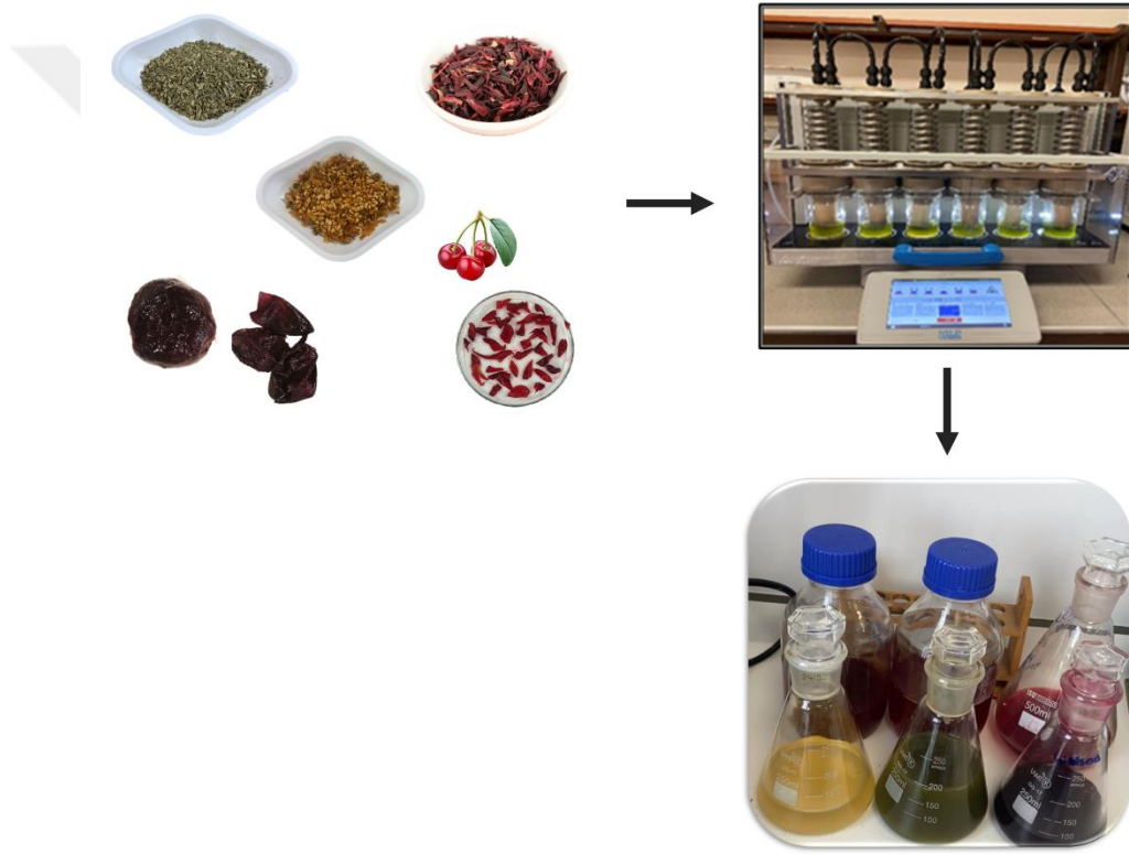
Şekil 3.3: Biyoatıkların ekstraksiyonu için OÇE sistemi.
