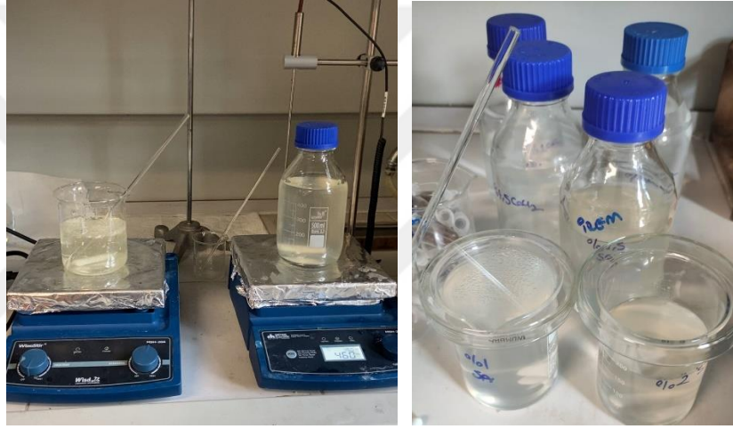
Şekil 3.4: Sodyum aljinat çözeltisinin hazırlanışı.
