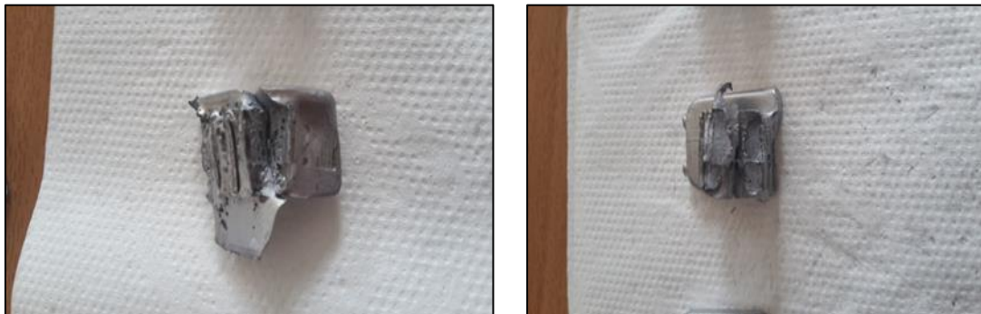
Resim 5.11. Deneme 3 kaynama yüzeyi hava boşlukları
