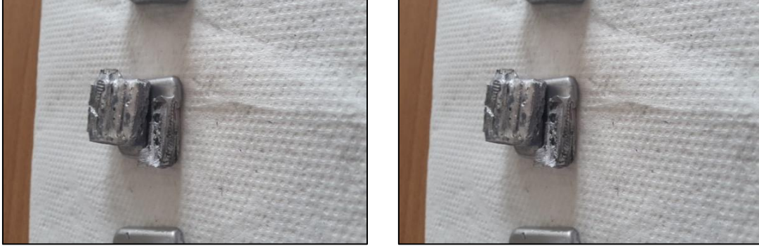
Resim 5.12. Deneme 4 kaynama yüzeyi hava boşlukları
