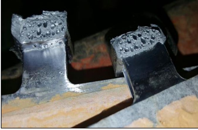
Resim 5.8. Kaynama yüzeyi hava boşlukları
