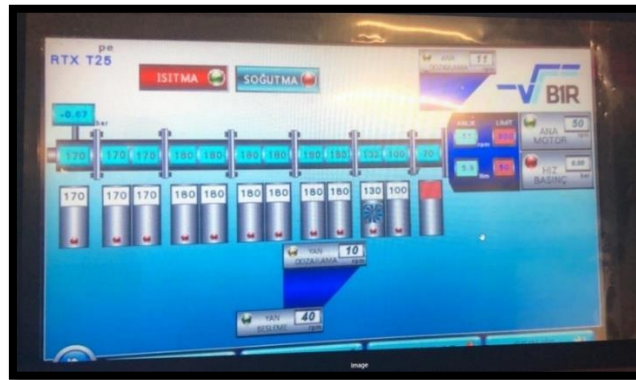
Şekil 5.30 PHA/PLA ve PHA/PBS biyoharmanlarının çift vidalı ekstrüder koşulları
