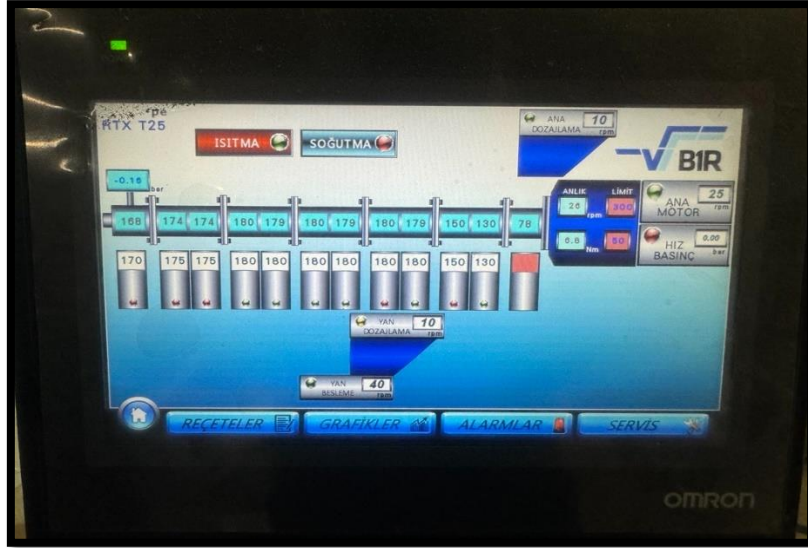
Şekil 5.31 PHA/PHB biyoharmanının çift vidalı ekstrüder koşulları
