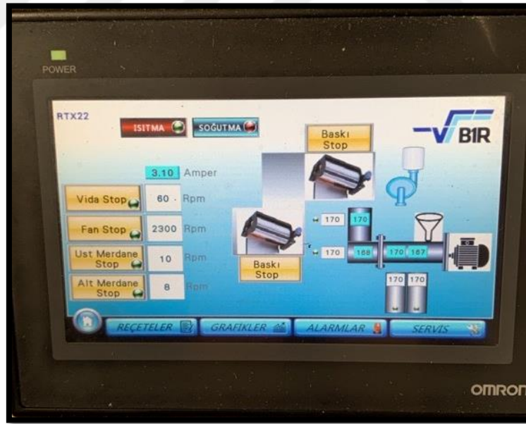
Şekil 5.32 Ekstrüzyon biyoharmanlarının şişirme film ekstrüderi koşulları
