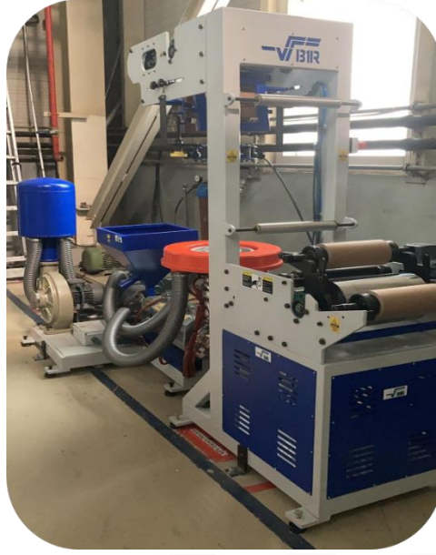
Şekil 4.4 Tek vidalı ekstrüder
