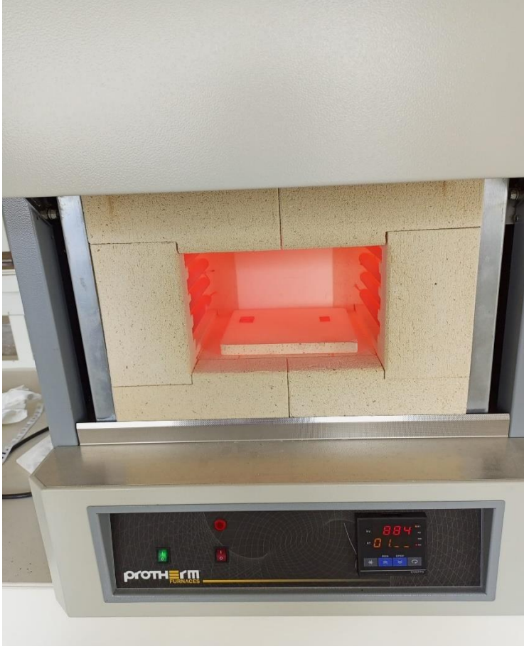
Şekil 3.19 1000 °C'de ısıtılan SS304 ile Incoloy 800H alaşımın kendiliğinden soğumaya bırakılma işlemi
