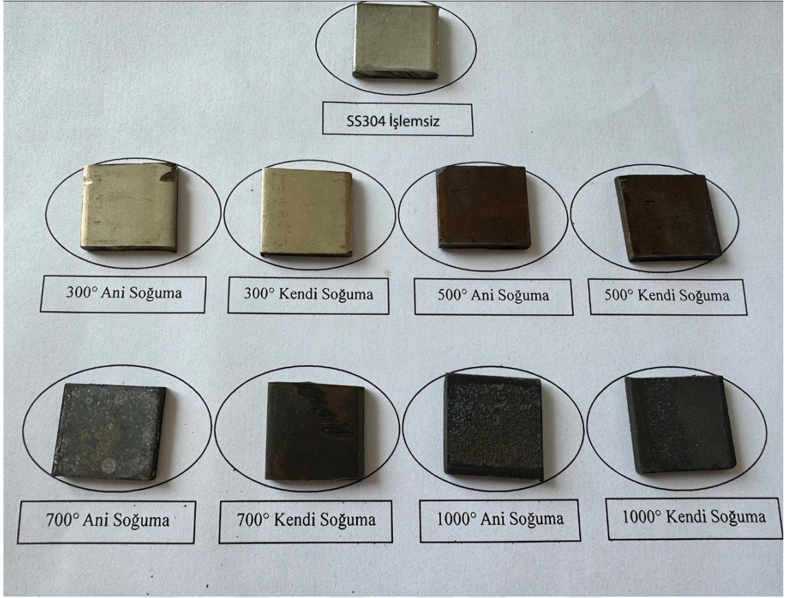
Şekil 3.23 SS304 alaşımın ısıtma-soğutma işlemi sonrası görselleri
