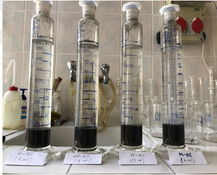
Şekil 5.9. Mezürde flokülasyon deneyi ve arayüzey yüksekliği ölçümü
