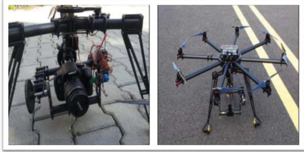
Şekil 2.4: Multikoptere monte edilmiş olan Canon EOS 650D Sayısal Fotoğraf Makinesi ve Multikopter.
