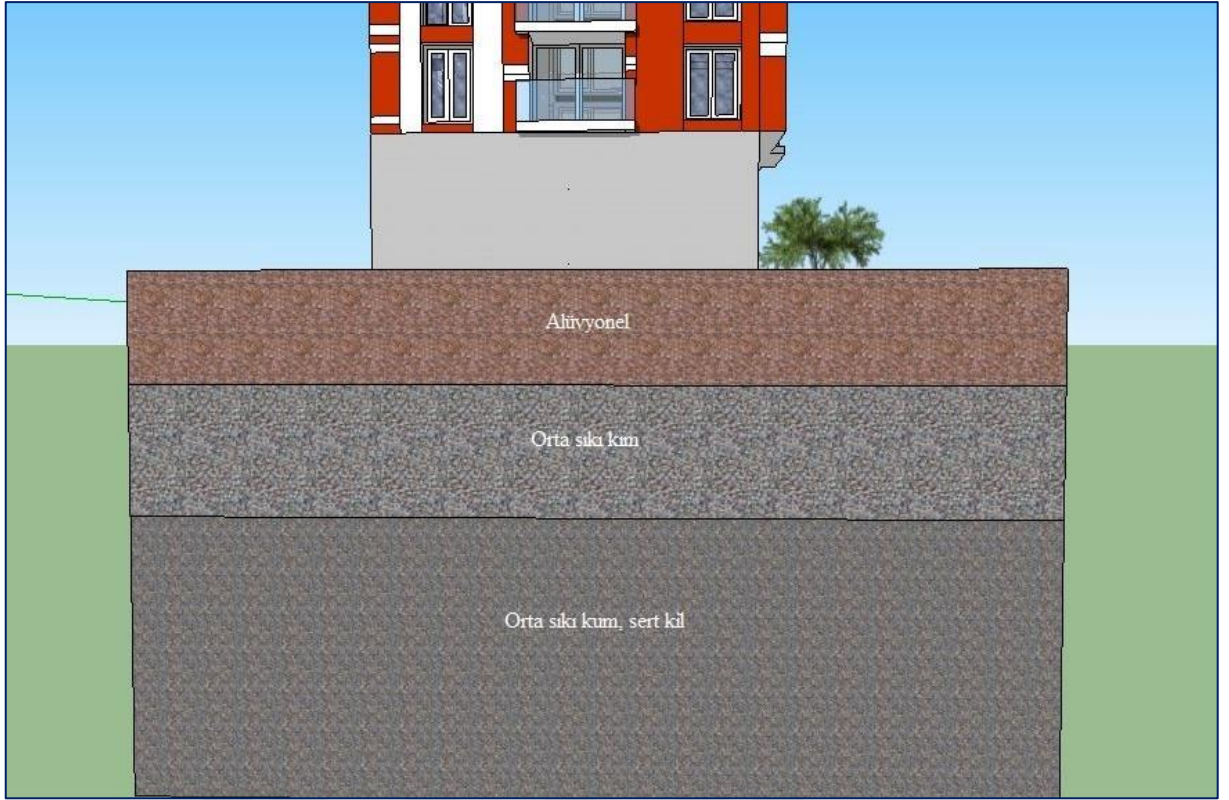
Şekil 4.12. Tilmerç mahallesi zemin tabakaları
