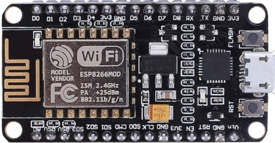
Şekil 19: Üzerinde ESP8266 Wi-Fi mikro çipi barındıran, programlanabilir NodeMCU elektronik kartı.
