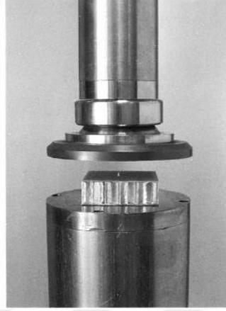
Şekil 2. 14. Düz bası testi (ASTM C365)
