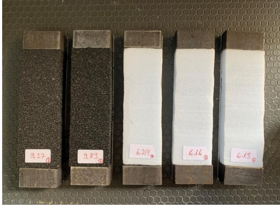
Şekil 3. 43. Hazırlanan XPS ve EPP köpük çekirdekli numuneler
