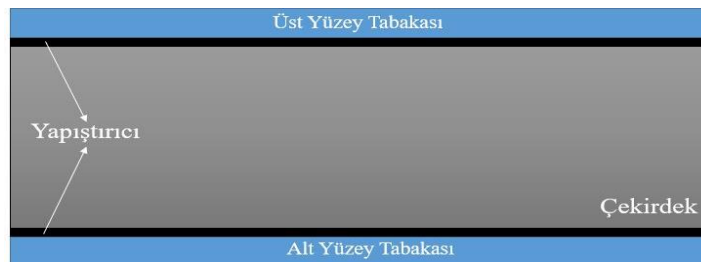
Şekil 2. 2. Sandviç yapıyı oluşturan bileşenlerin şematik gösterimi
