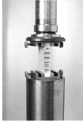
Şekil 2. 15. Enlemesine bası testi (ASTM C364)
