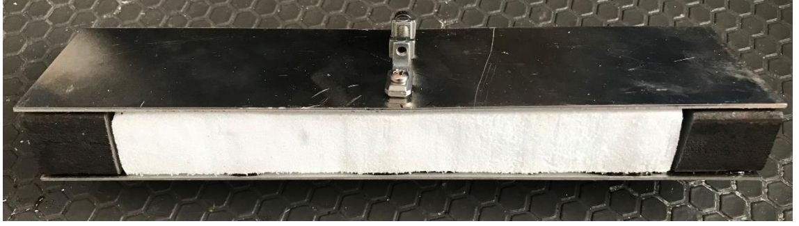
Şekil 3. 44. Deplasman sensörü aparatı bağlanarak teste hazır hale getirilen numuneler
