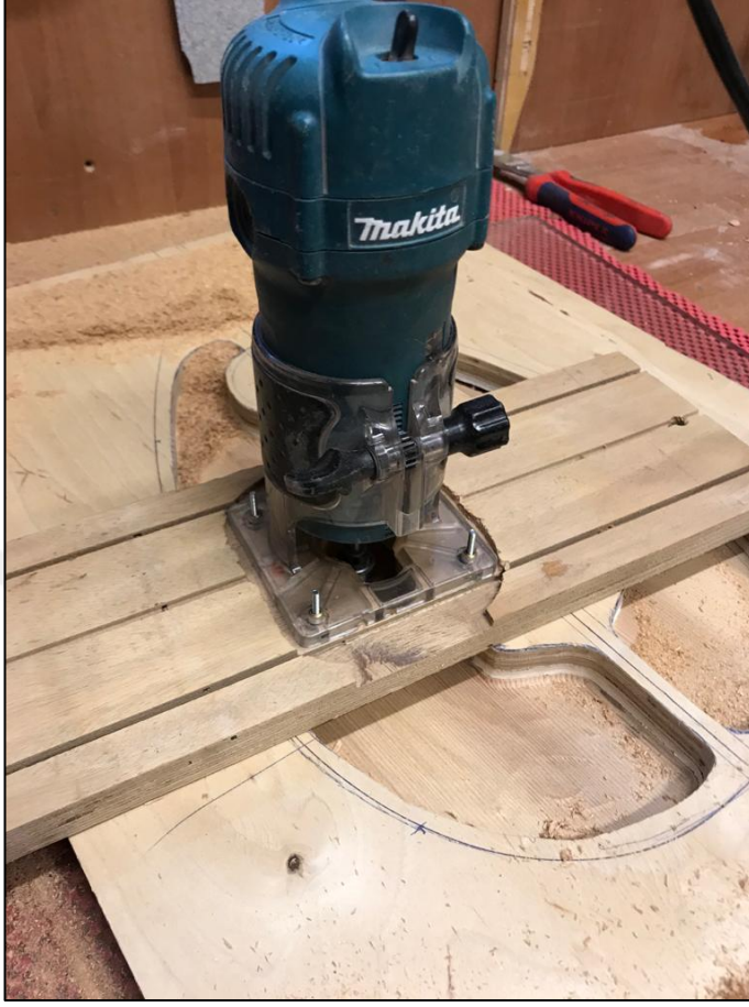
Şekil 6.9: Gizli oyuk açılması
