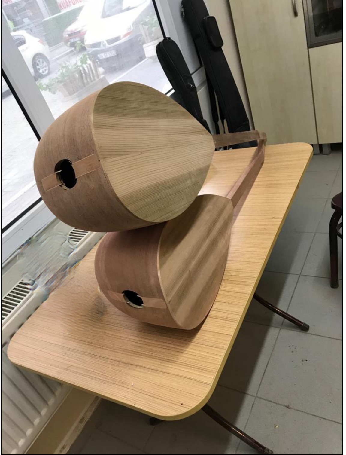
Şekil 3.44: Cila ve perde bağlanması için hazır haldeki bağlamalar
