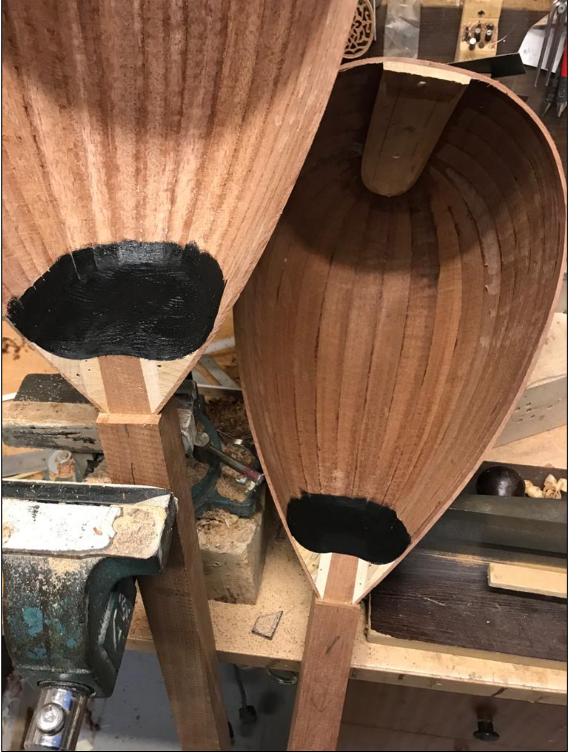
Şekil 3.39: Bağlama kapaklarının takılması için hazır olan bağlamalar
