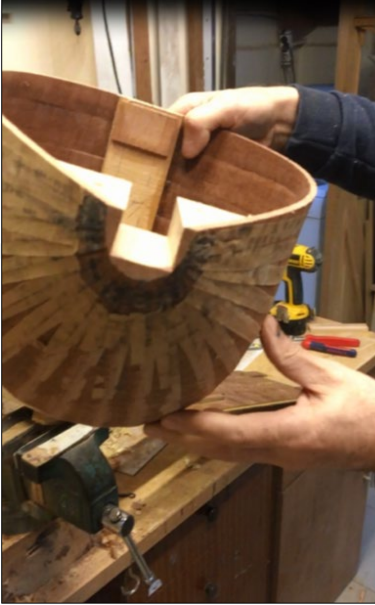
Şekil 3.31: Sap oyuğunun netleşmesi
