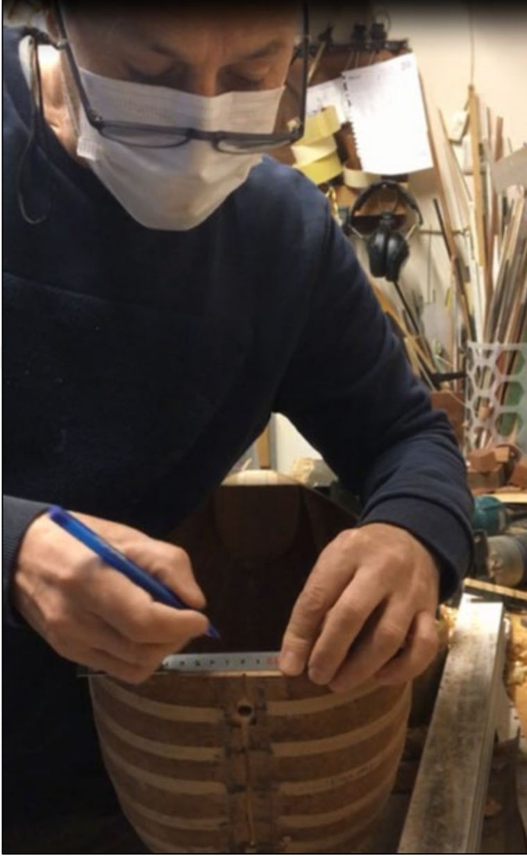
Şekil 3.18: Sap merkezi için ölçüm alınması
