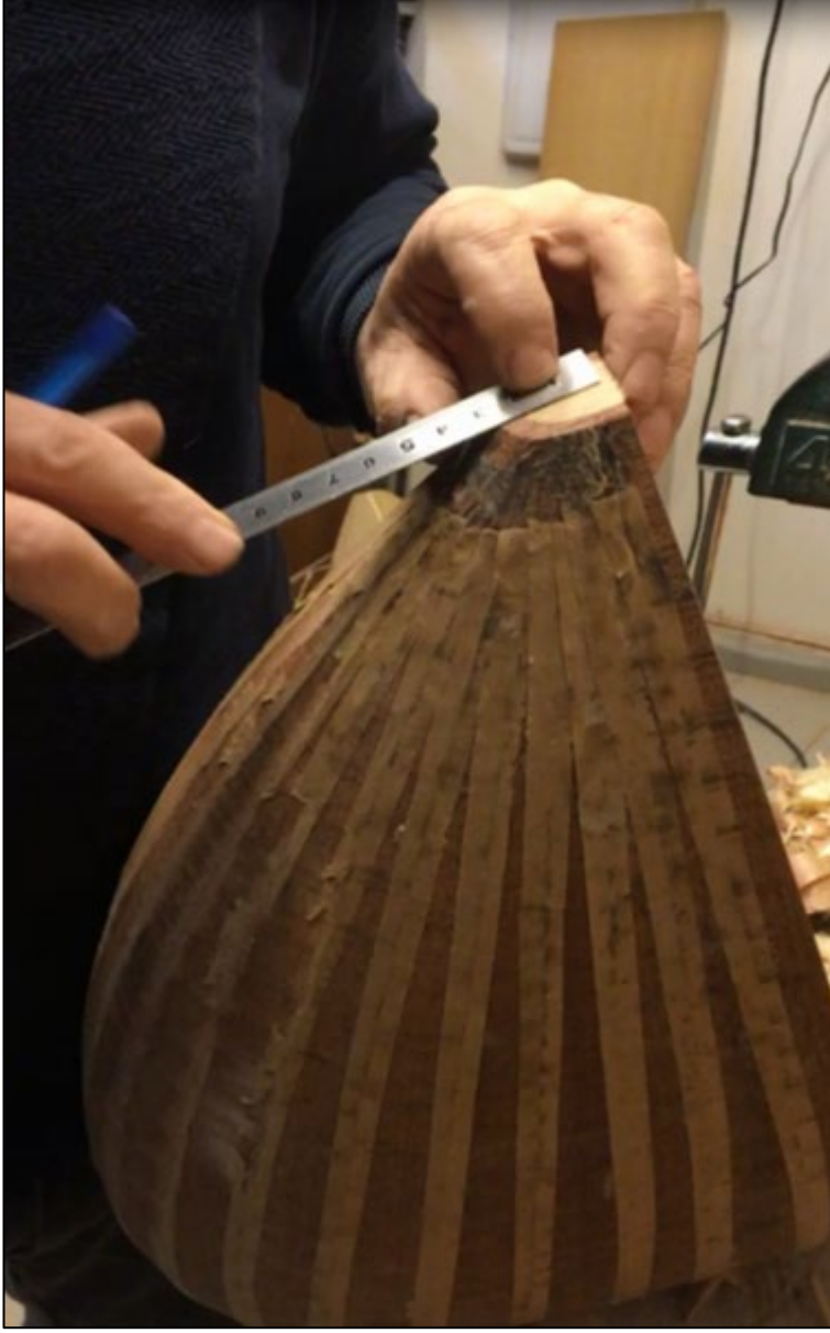
Şekil 3.24: Teknenin sap oyuğu için ölçüm işlemi
