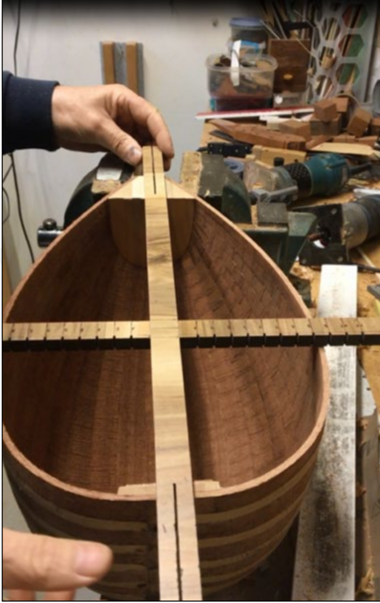
Şekil 3.22: Sapın konumlandırılması için ölçümün alınması
