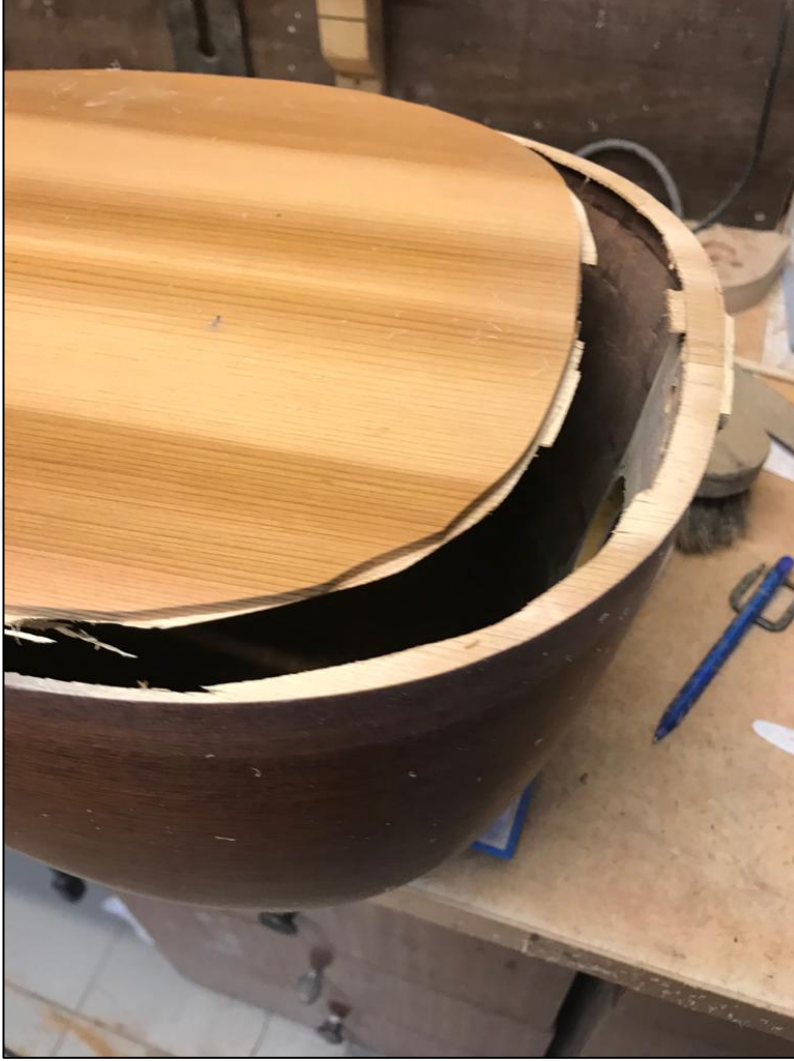
Şekil 6.3: Kapak kısmının tekneden ayrılması
