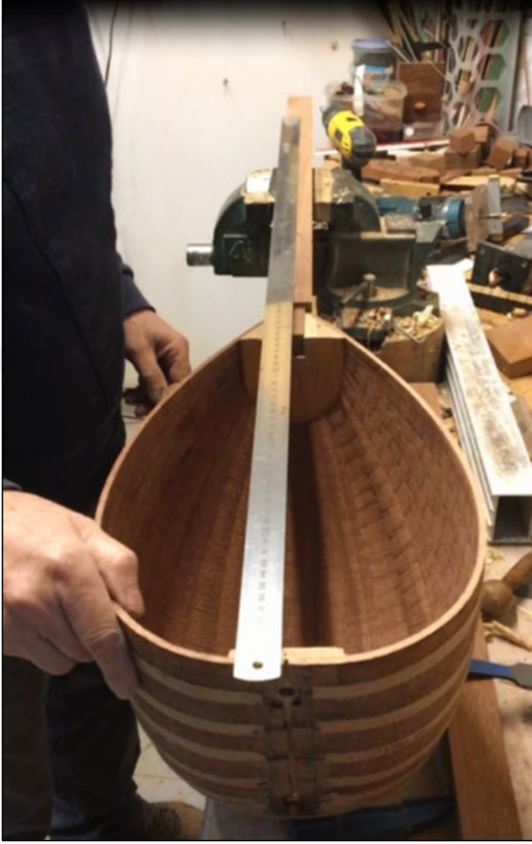
Şekil 3.36: Sapın teknede oturduğu konumun doğruluğunun ölçülmesi
