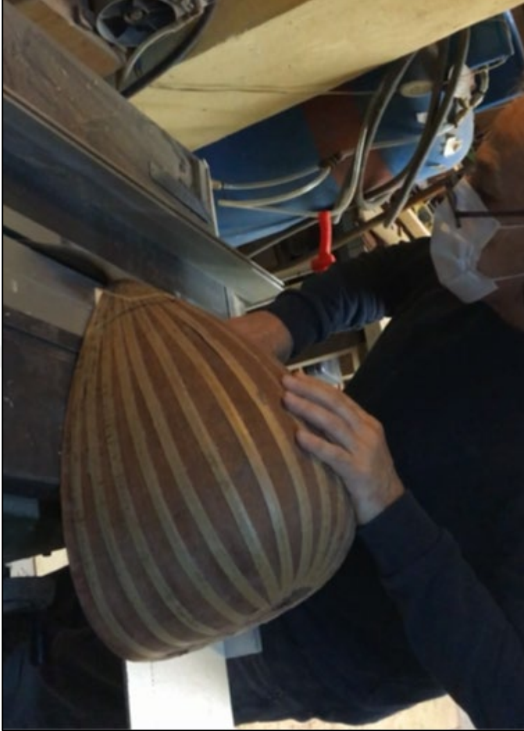
Şekil 3.23: Sap alıştırması için tekne hazırlanmaya başlaması
