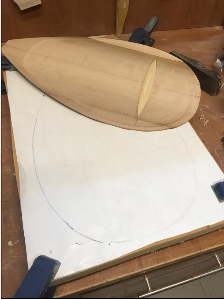
Şekil 6.8: Kapak kesimi ve eşige denk ahşap eklenmesi
