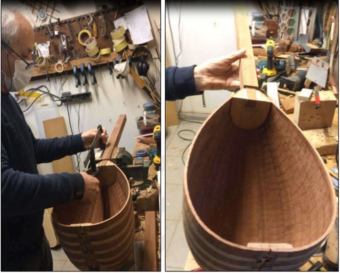
Şekil 3.37: Sapın tekneye oturtulması işlemi
