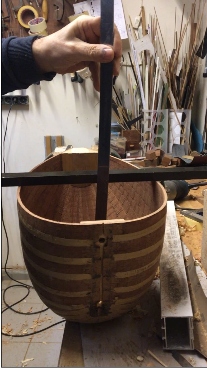
Şekil 3.12: Tekne derinliđi ölçümü görseli
