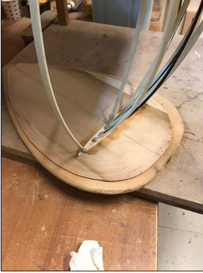
Şekil 6.7: Kapak eşiğine denk ahşap eklenmesi
