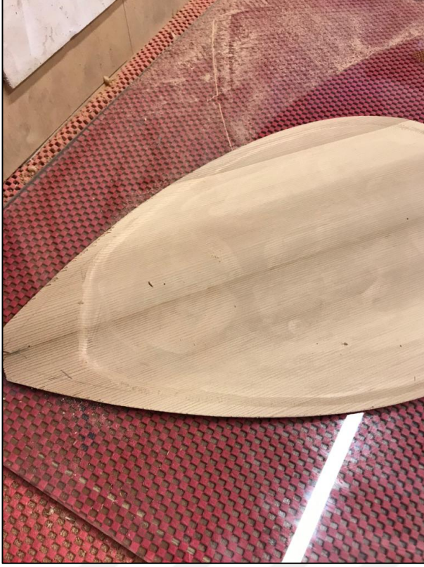
Şekil 6.6: Kalıba göre yeni kapak kesilmesi
