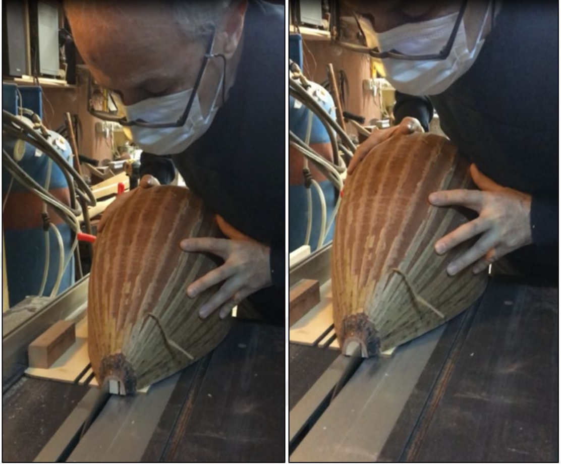
Şekil 3.27: Sap oyuğunun sağ ve soldan açılma işlemi
