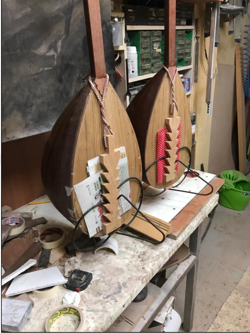
Şekil 6.14: Cilalanmaya hazır bağlamalar
