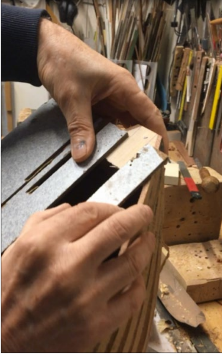
Şekil 3.25: Teknede sap oyuğunun işaretlenmesi
