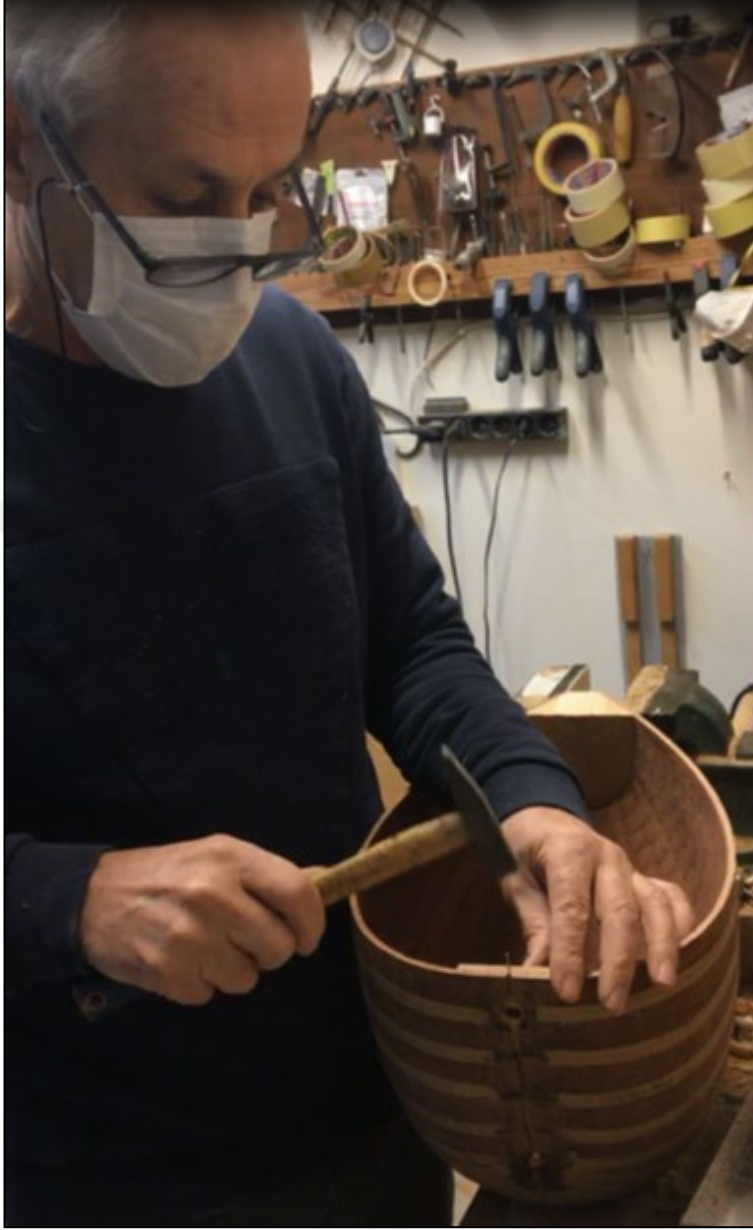
Şekil 3.21: Sapın sabitlenmesi için çivi çakılması
