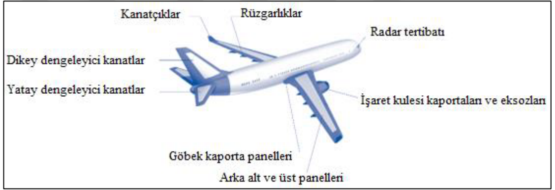
Şekil 4.13: Yolcu uçağının iç yapısında kullanılan kompozit yapıların kullanım bölgeleri
