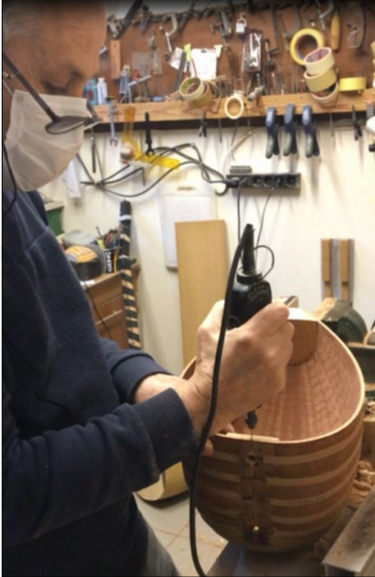
Şekil 3.19: Sap için delik açma işlemi
