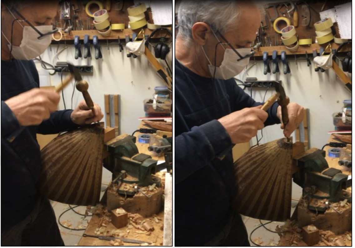
Şekil 3.29: Oyuk bölgenin kabasının alınma işlemi
