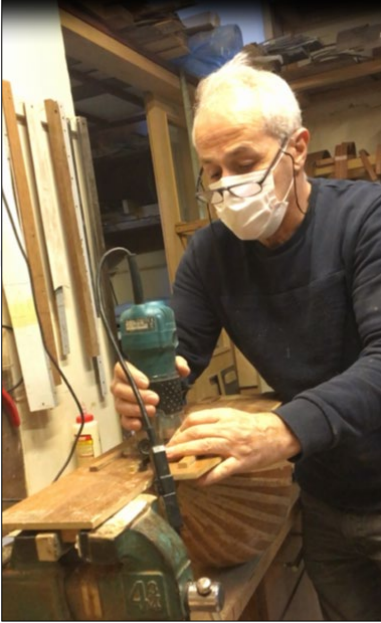
Şekil 3.26: Teknede sap oyuğunun oluşturulması
