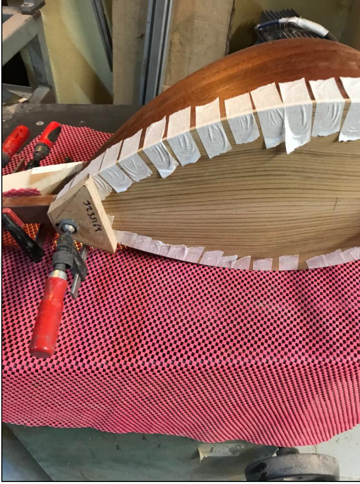
Şekil 6.13: Tekne ile kapağın birleştirilmesi
