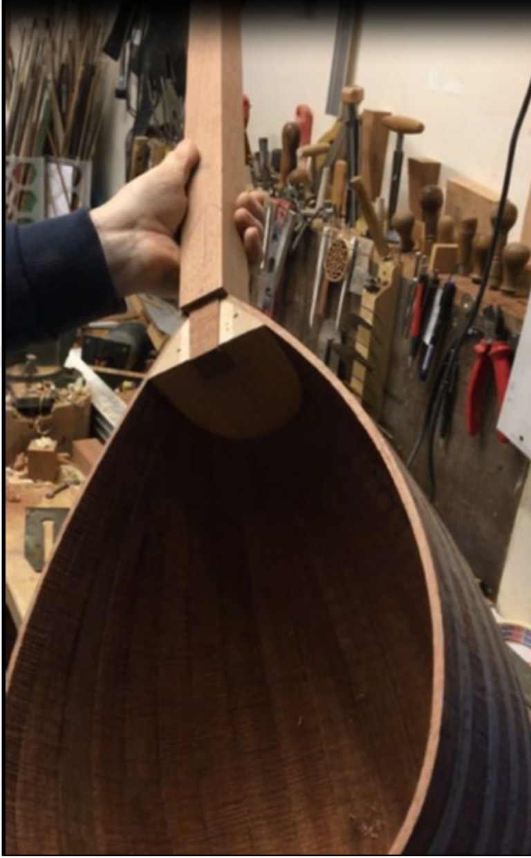
Şekil 3.38: Tekneye iyice oturan sapın yapıştırma aşamasına getirilmesi
