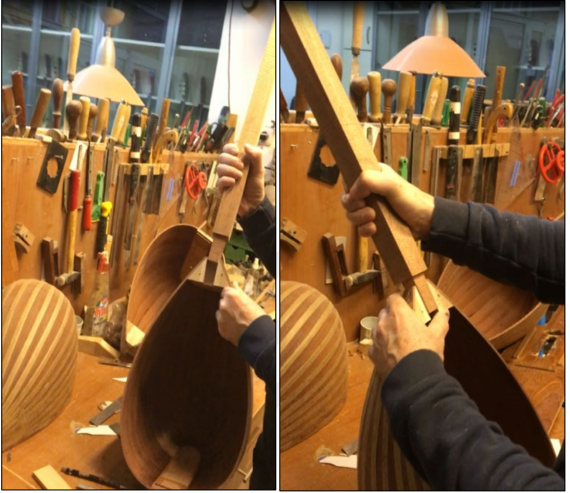
Şekil 3.35: Sapın teknedeki oyuğa denenmesi
