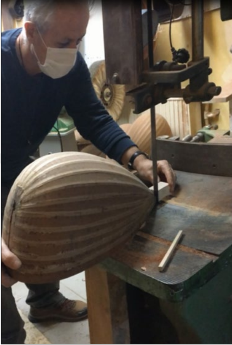
Şekil 3.8: Teknenin üzerindeki sap oyuğu açılacak kısmın kesimi
