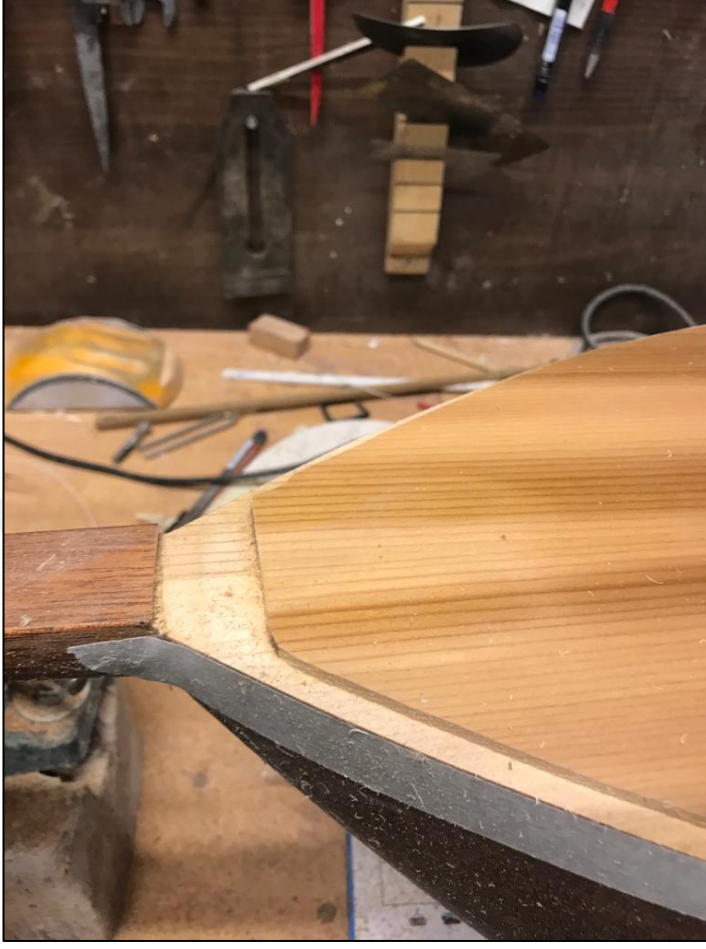
Şekil 6.2: Geleneksel bağlamanın kapak söküm işlemi
