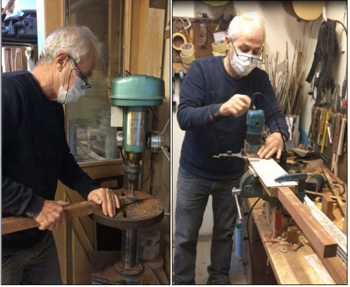
Şekil 3.34: Sapın teknedeki oyuğa göre şekillendirilmesi işlemi
