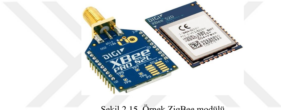
Şekil 2.15. Örnek ZigBee modülü
