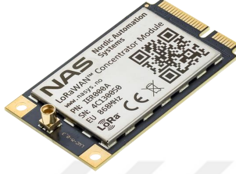
Şekil 2.19. Örnek LoRaWAN modülü
