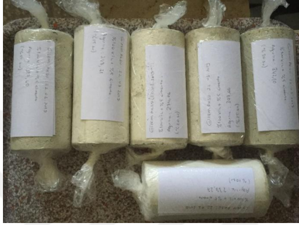
řekil 3.4. Serbest basın deneyi numuneleri k¼r ařaması
