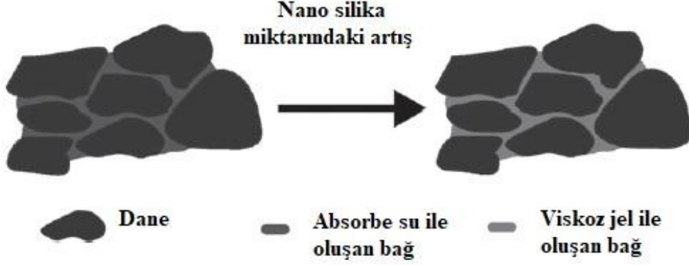
Şekil 4.9. Kil partikülleri arasında nano silika etkisi ile oluşan bağ (Changizi ve Haddad, 2017)
