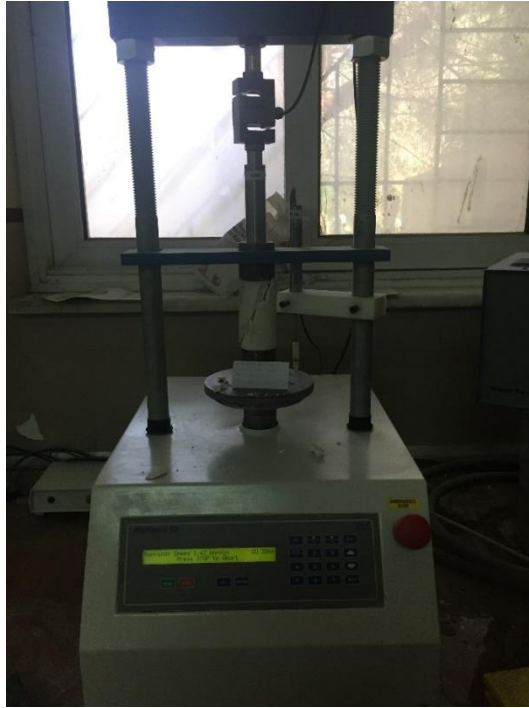
řekil 3.5. Serbest basın deneyi numunelerinin kırım ařaması
