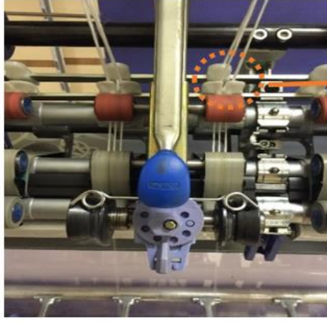
Şekil 1.37 Üç fitil büküm ipliği üretim yöntemi (Demir ve Kılıç, 2020)
