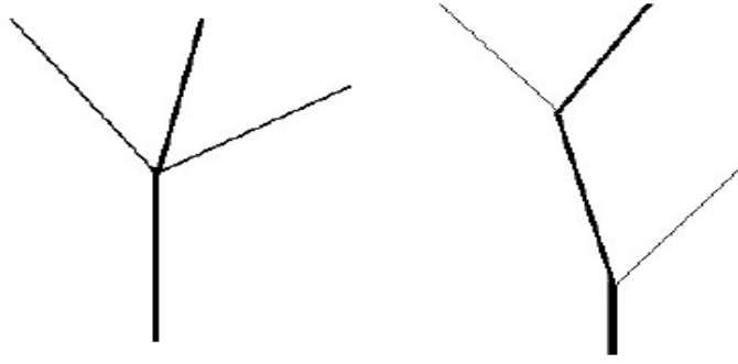
Şekil 2.22 Üç fitil iplikçilikte oluşabilecek asimmetrik eğirme üçgeni yapıları (He,2007)
