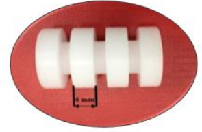
Şekil 1.38 İletici silindirli üç fitil büküm ipliği üretim yöntemi (Demir ve Kılıç, 2020)
