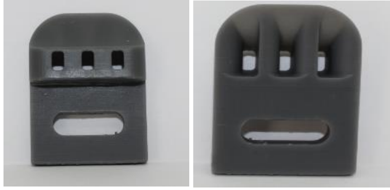
Şekil 2.32 Üç boyutlu yazıcıda üretilen üçlü fitil hunisi (Kişisel arşiv, 2021)
