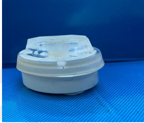
Şekil 2.88 Enine kesit almak için hazırlanan numuneler (Kişisel arşiv, 2021)
