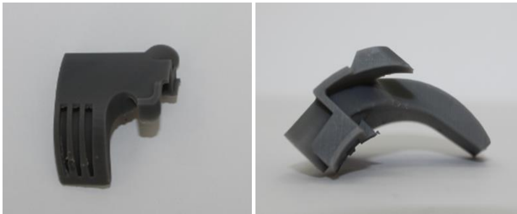
Şekil 2.53 Üç boyutlu yazıcıda üretilen hava emiř parçası-2 (Kişisel arşiv, 2021)
