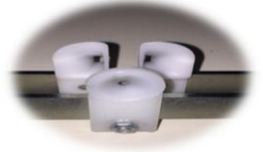
Şekil 1.37 Üç fitil büküm ipliği üretim yöntemi (Demir ve Kılıç, 2020)
