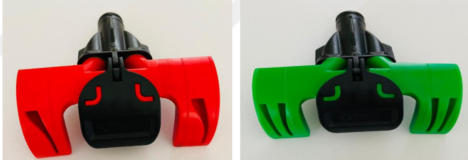
Şekil 2.48 Rieter kompakt tek katlı ve kompakt siro-spun iplikleri için kullanılan hava emiř parçaları (Kiřisel arřiv, 2021)
