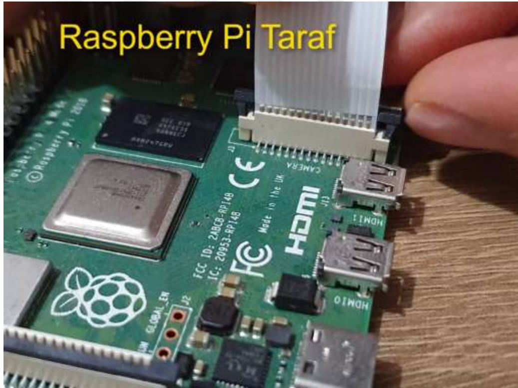
Şekil 2.16 Pi Kamera Kurulumu RPi 3 Tarafından Gösterimi
