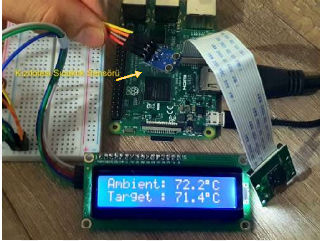
Şekil 2.44 Raspberry Pi 3 IoT cihazının CPU tepe noktasından çekilen sıcaklığı
