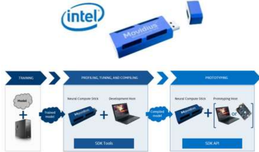
Şekil 2.9 Intel® Movidius™ Vision Processing Units (VPUs) [85]
