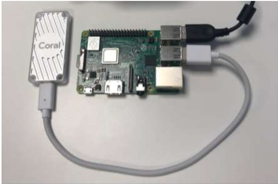
Şekil 2.22 USB Coral eşlik eden kısa USB-C - USB-A kablosu kullanılarak takılmıştır [82].
