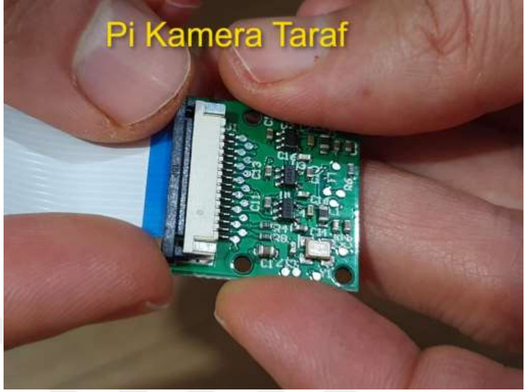
Şekil 2.15 Pi Kamera Kurulumu Kamera Tarafından Gösterimi
