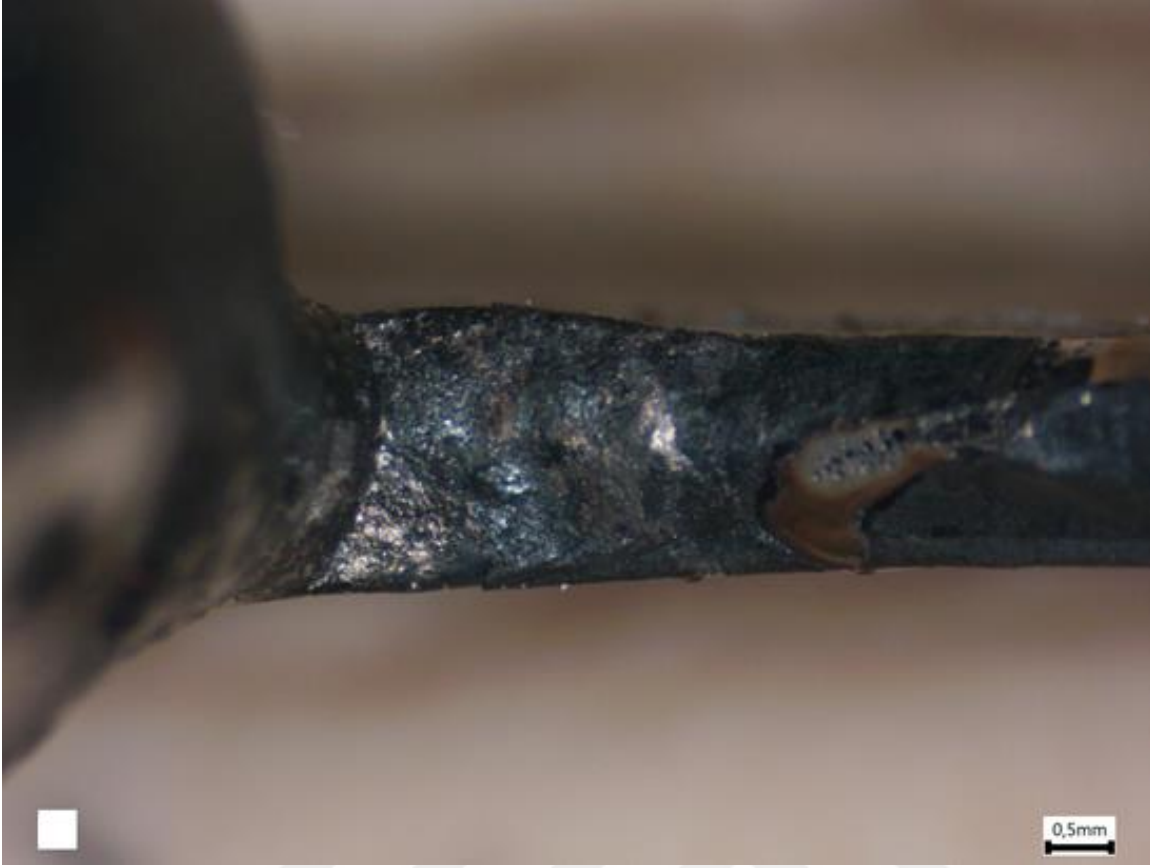
Şekil 5.14 : Gazaltı kaynağı ile birleştirilmiş 1 numaralı numuneye ait kopma yüzeyi görüntüsü.
