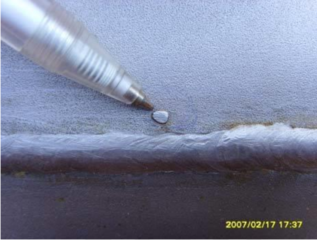
Şekil 3.16 : Kaynak bölgesinde sıçrama oluşumu (Al-Madani, Abdalla, Azoumi, & Elkoum, 2009).
