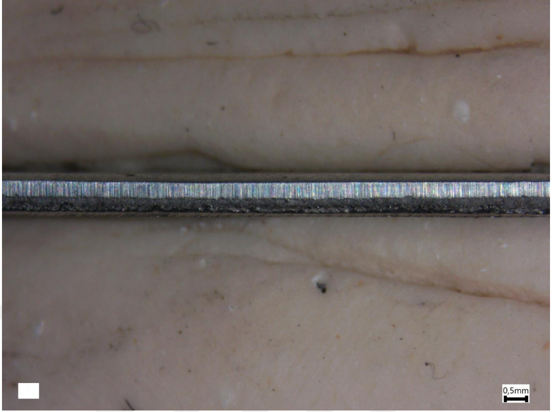
Şekil 5.21 : Lazer kaynağı ile birleştirilmiş 3 numaralı numuneye ait kopma yüzeyi görüntüsü.
