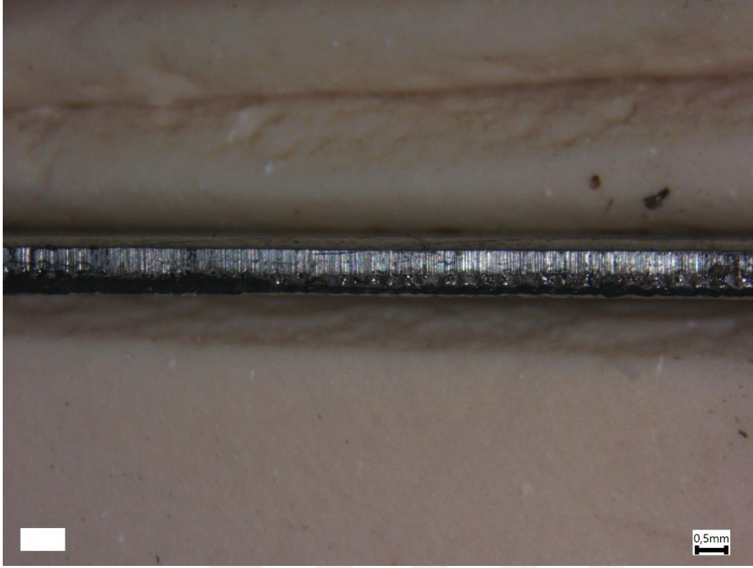
Şekil 5.26 : Lazer kaynağı ile birleştirilmiş 8 numaralı numuneye ait kopma yüzeyi görüntüsü.
