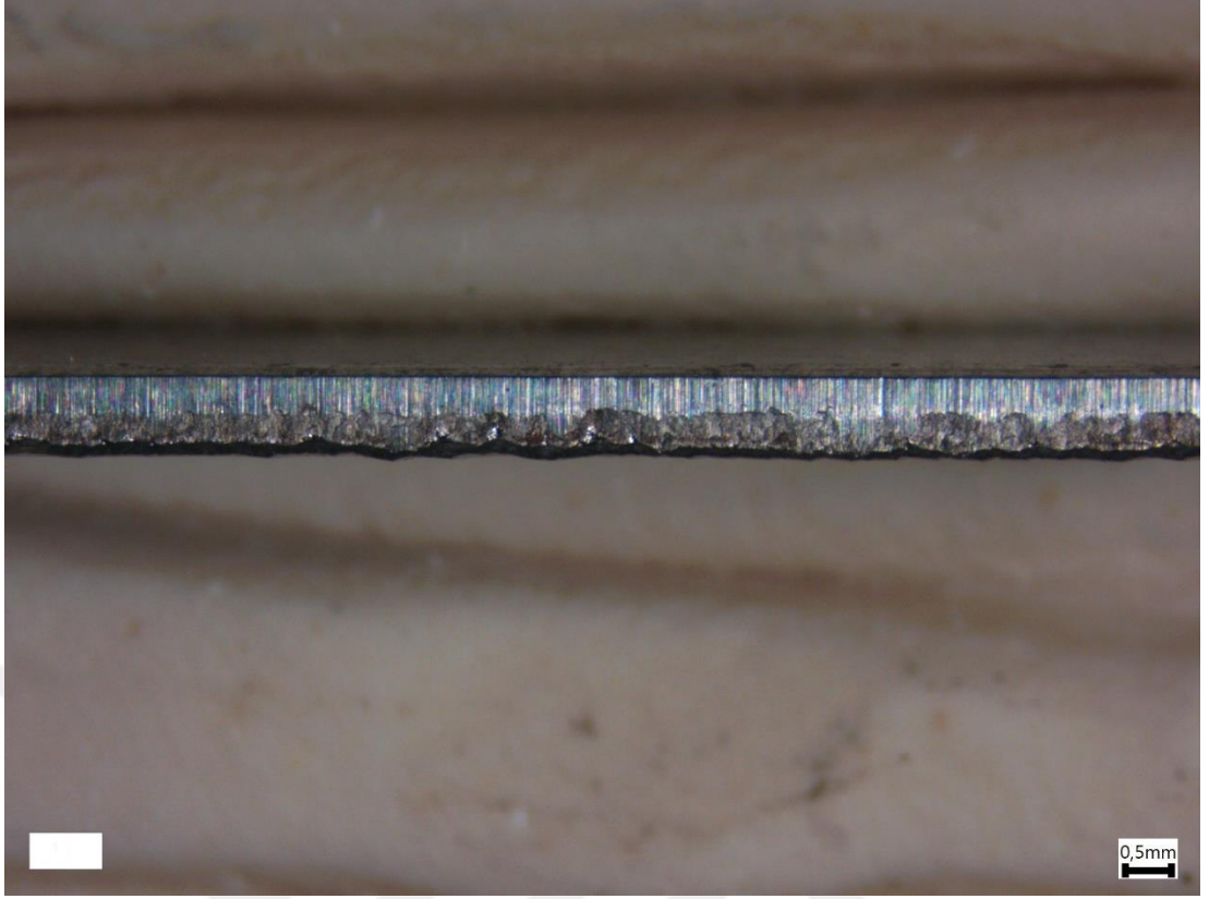
Şekil 5.27 : Lazer kaynağı ile birleştirilmiş 9 numaralı numuneye ait kopma yüzeyi görüntüsü.
