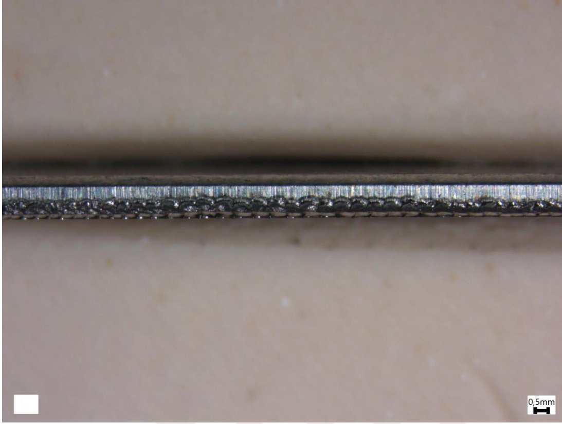
Şekil 5.24 : Lazer kaynağı ile birleştirilmiş 6 numaralı numuneye ait kopma yüzeyi görüntüsü.
