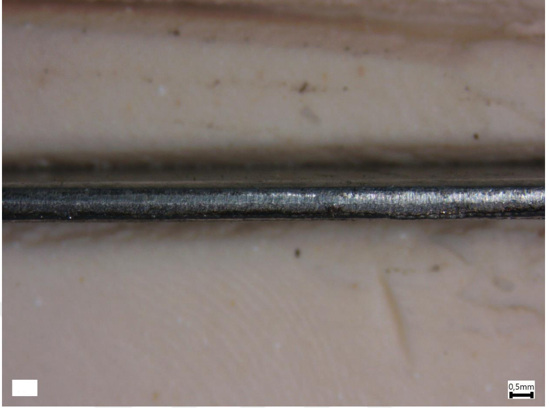
Şekil 5.23 : Lazer kaynağı ile birleştirilmiş 5 numaralı numuneye ait kopma yüzeyi görüntüsü.
