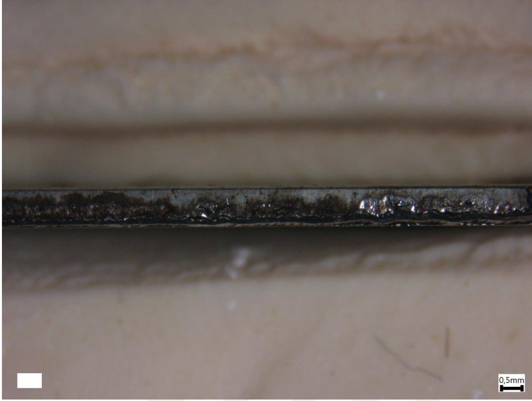
Şekil 5.22 : Lazer kaynağı ile birleştirilmiş 4 numaralı numuneye ait kopma yüzeyi görüntüsü.
