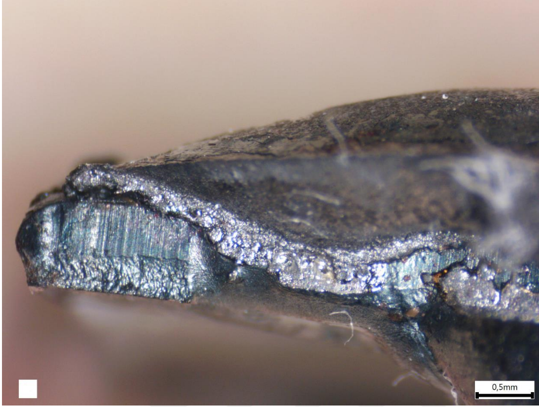
Şekil 5.18 : Gazaltı kaynağı ile birleştirilmiş 6 numaralı numuneye ait kopma yüzeyi görüntüsü.
