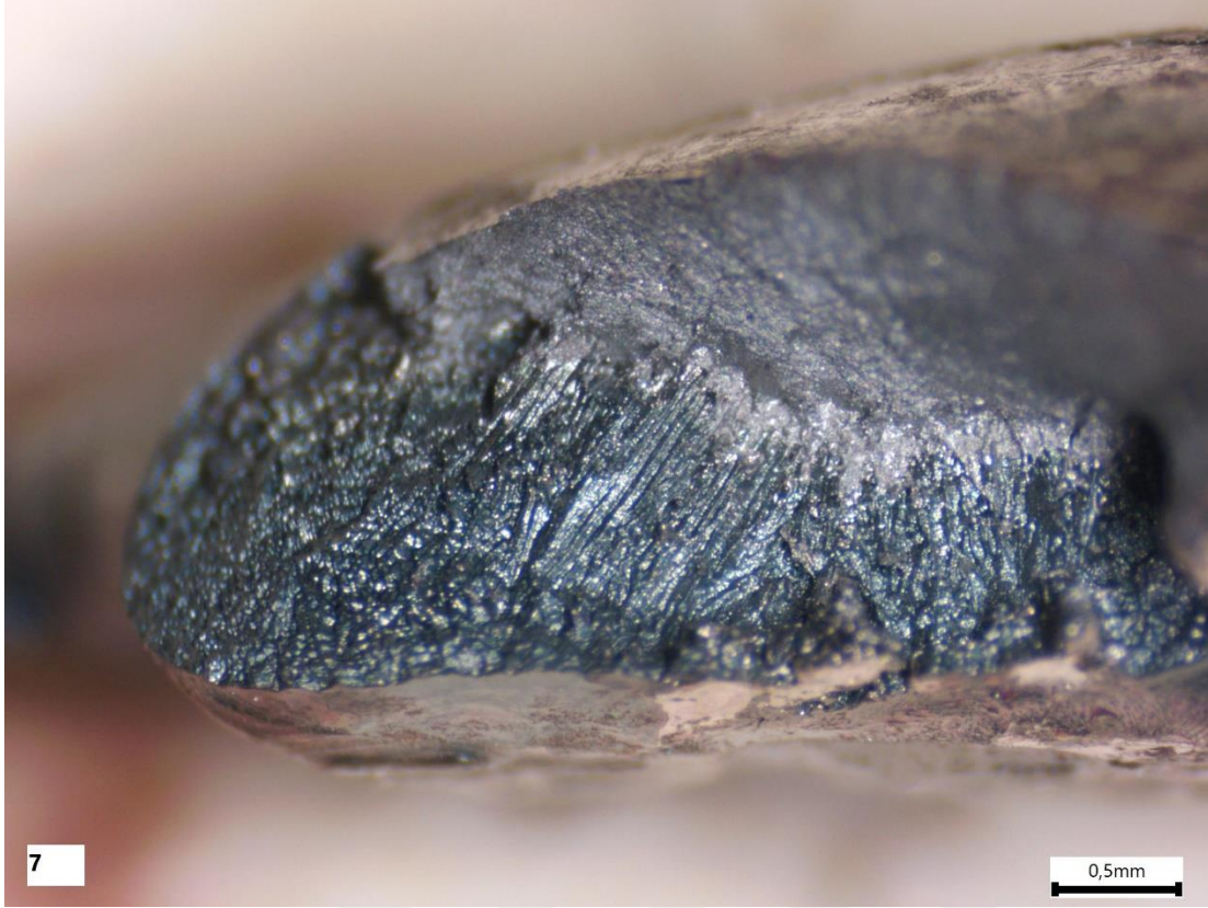
Şekil 5.16 : Gazaltı kaynağı ile birleştirilmiş 3 numaralı numuneye ait kopma yüzeyi görüntüsü.
