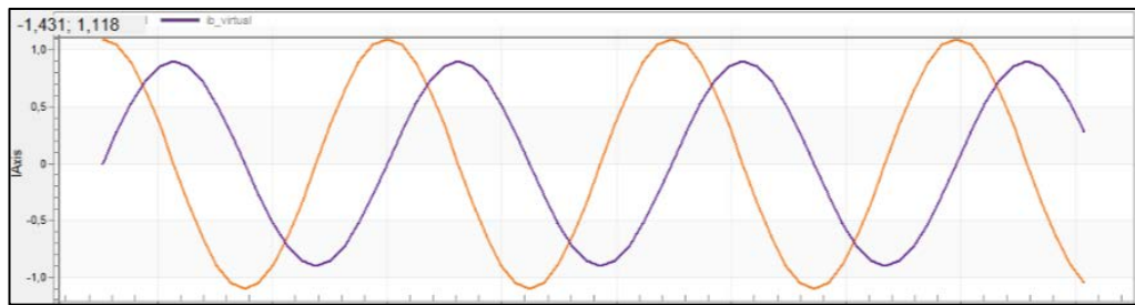
Şekil 5.14: 180° rotor açısı için elde edilen sanal akım sinyali.
