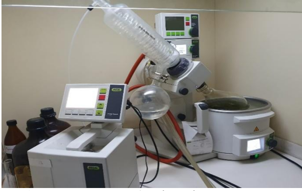
Resim 6. Rotavapor (geri çeviren soğutucu) ile çözücünün ortamdan uzaklaştırılması
