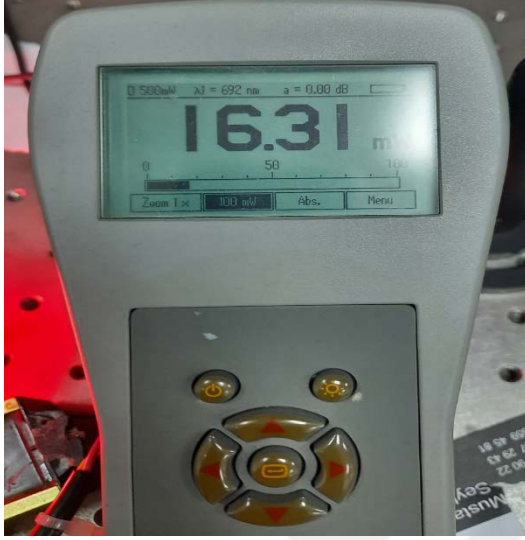
Şekil 3.2. Işık şiddet ölçümü ve ışık kaynağı düzeneği
