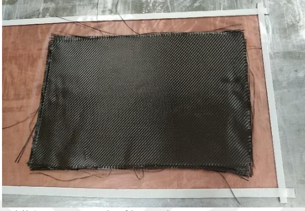
Şekil 3.6. Karbon elyaf kumaşlarının film üzerine serilmesi
