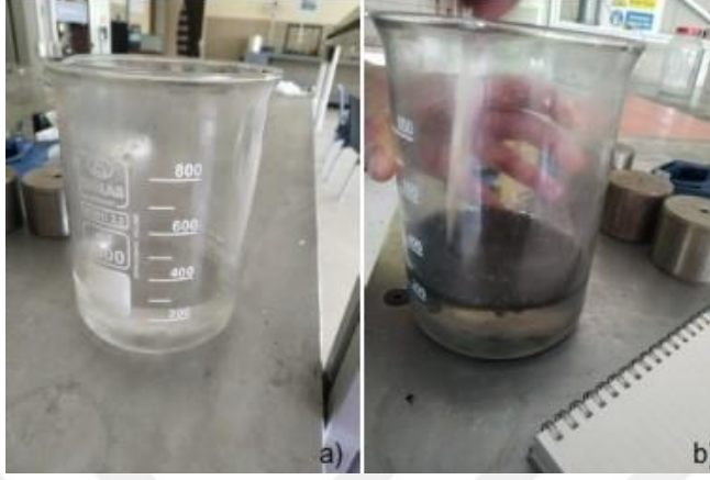
Şekil 3.2. Epoksi ile B 4 C partiküllerinin birleştirilmesi
