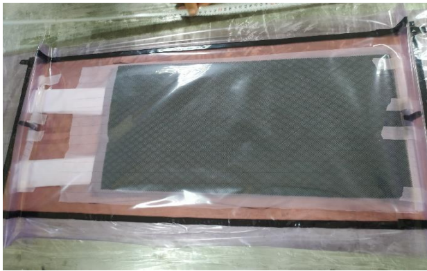
Şekil 3.10. Sistemin vakum poşeti ile kaplanması
