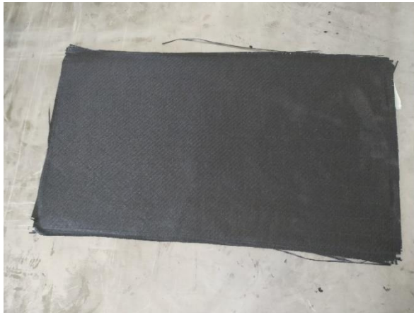
Şekil 3.12. Üretilen kompozit plakalar
