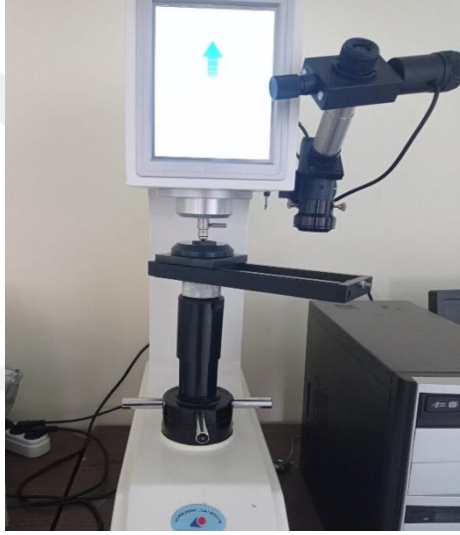
Şekil 3.17. Rockwell sertlik cihazı
