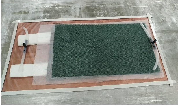
Şekil 3.9. Bağlantı parçalarının sisteme yerleştirilmesi
