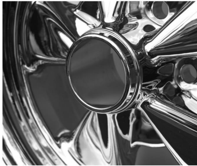
Şekil 2. 4. Dekoratif amaçlı nikel kaplanmış jant (Anonim, 2020j)
