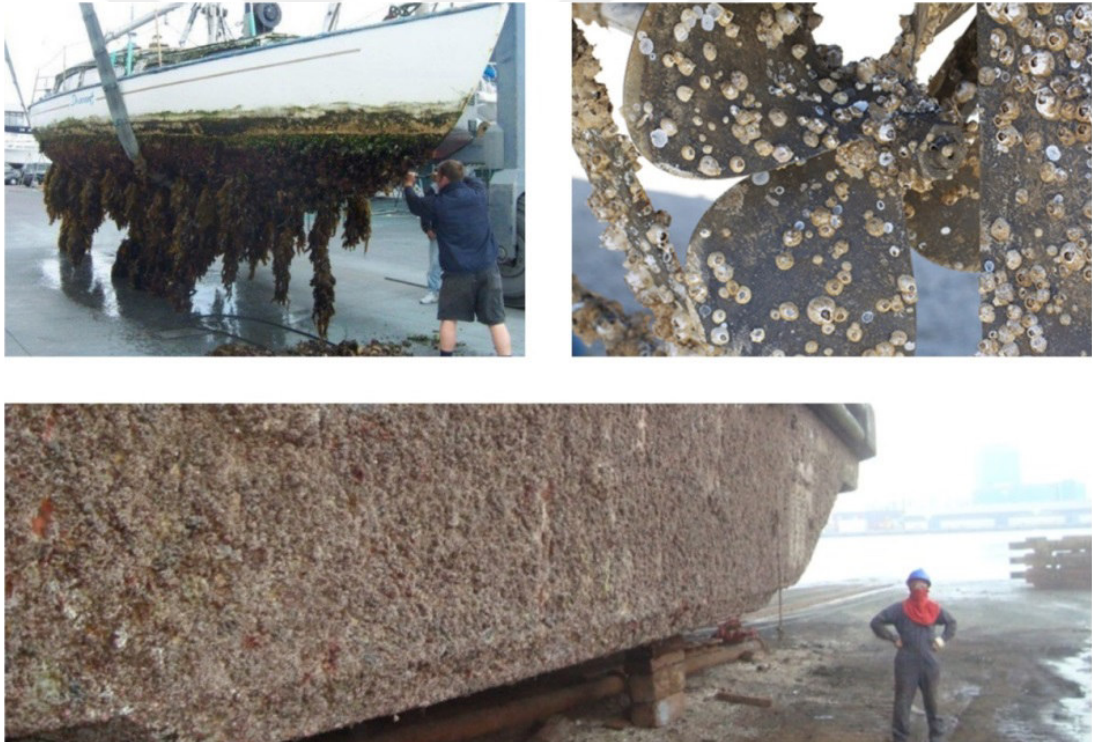
Şekil 2.3. Bazı su taşıtlarında kekamoz oluşumu a. Tekne tabanında alg kaynaklı yumuşak kekamoz (Anonymus, 2018a) b. Pervane ve dümen üzerinde kaya midyesi kaynaklı sert kekamoz (Arnst, 2017) c. Gemi karinasında kekamoz (Anonymus, 2013)
