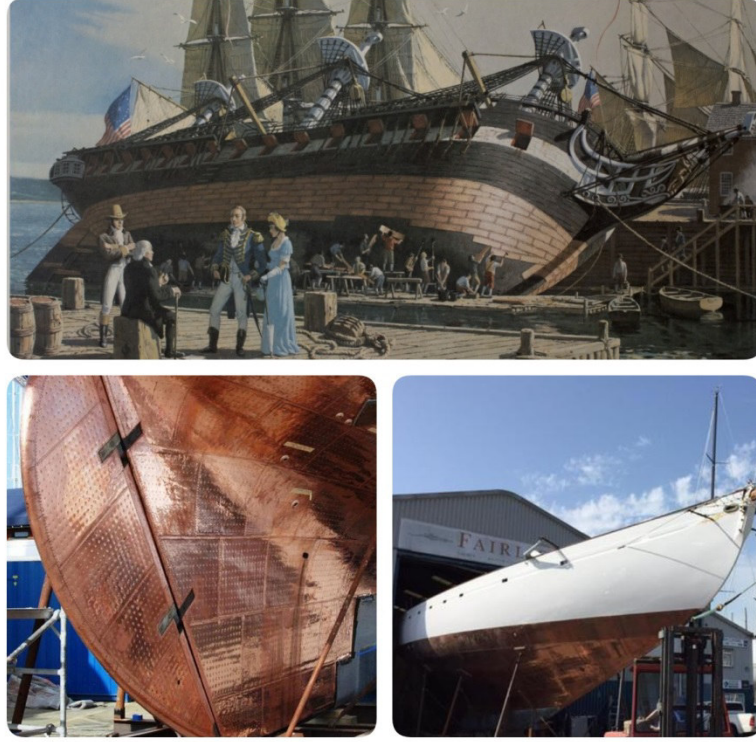
Şekil 2.6. Karinada bakır kaplama örnekleri, a. Bakır kaplama temsili (USS-Constitution-Museum, 2015), b. Eski bir gemide bakır kaplama rekonstrüksiyonu (Anonymus, 2015)
