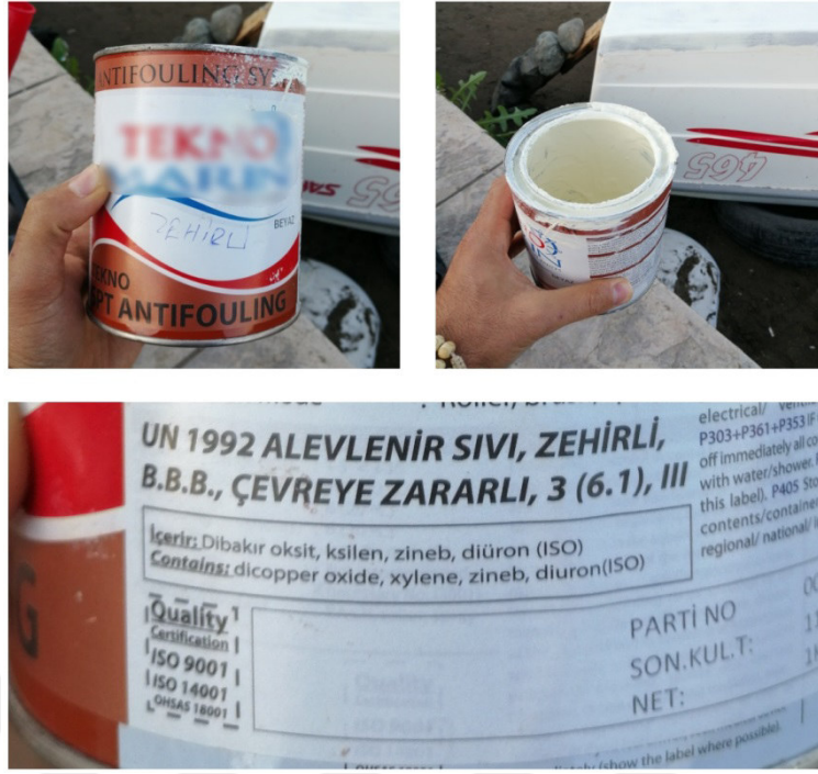
Şekil 2.10. Ülkemizde piyasada bulunan bakır oksit, zineb ve diuron içeren kekamoz önleyici boya
